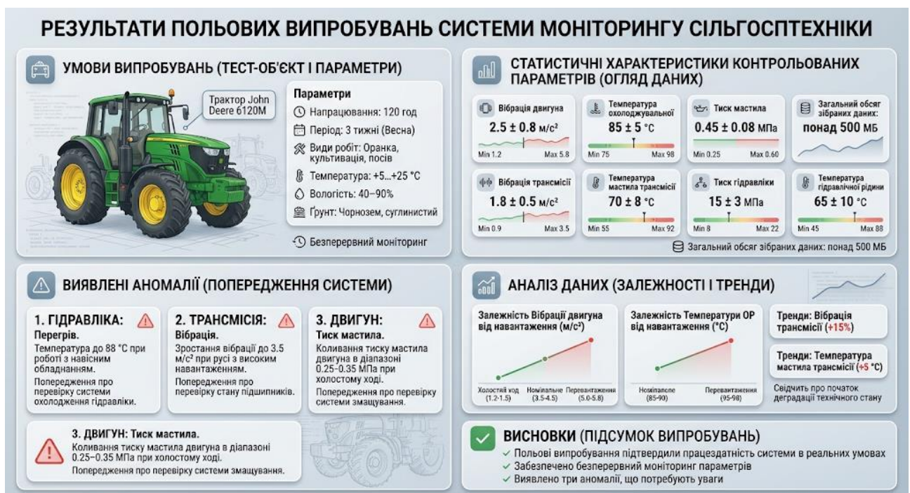
Рисунок 3.3 – Результати польових випробувань системи моніторингу сільгосптехніки
