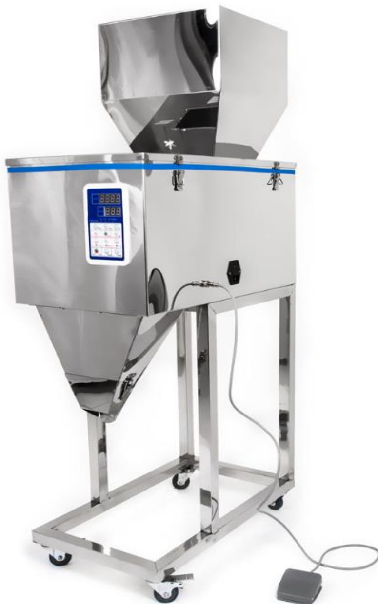
Рисунок 3.6 - Промисловий дозатор для сипучих матеріалів, ( Чехія)
