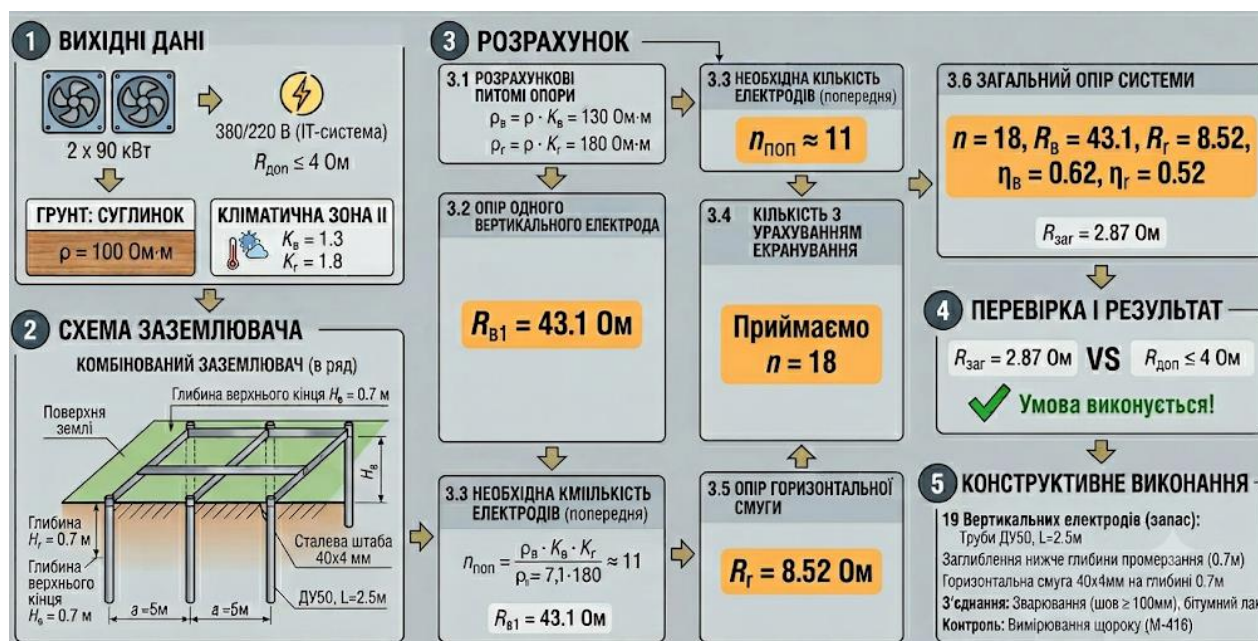
Рисунок 4.1 – Графічна схема: розрахунок захисного заземлення вентиляційного обладнання
