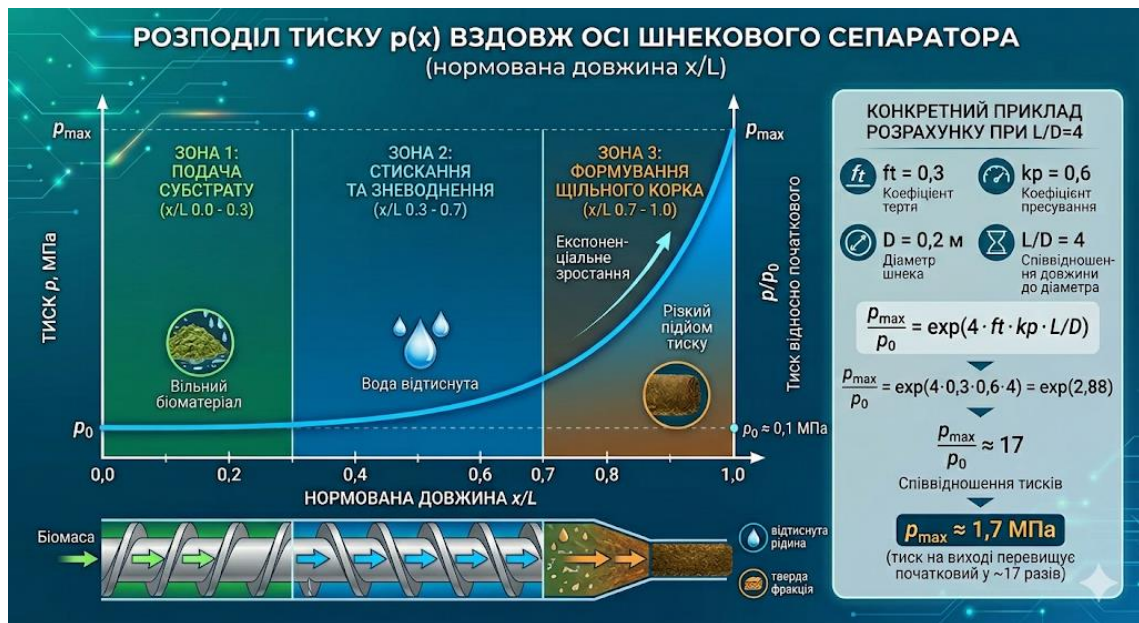
Рисунок 2.3 – Розподіл тиску p(x) вздовж осі шнека (нормована довжина x/L )
