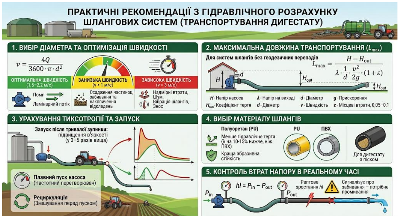
Рисунок 3.3 – Практичні рекомендації з гідравлічного розрахунку шлангових систем (транспортування дигестату)
