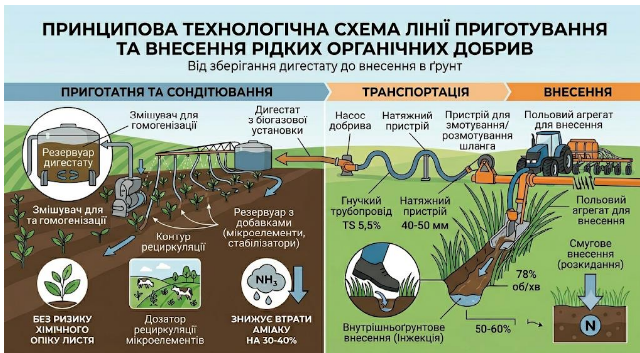
Рисунок 3.5 – Принципова технологічна схема лінії приготування та внесення рідких органічних добрив]
