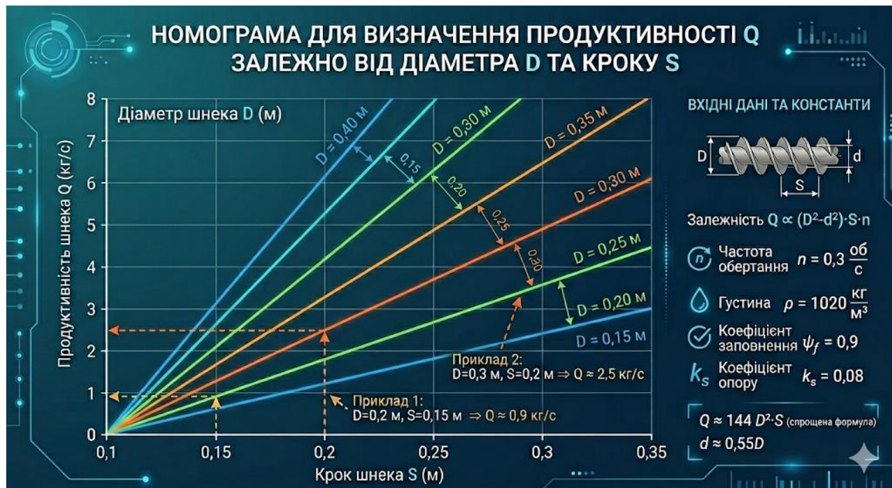
Рисунок 2.5 – Номограма для визначення продуктивності Q залежно від діаметра шнека D та кроку S
