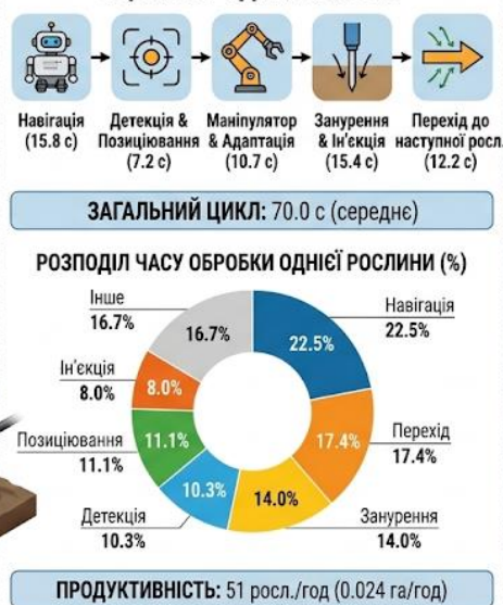
Рисунок 3.2 – Результати польових випробувань роботизованого ін'єктора добрив
