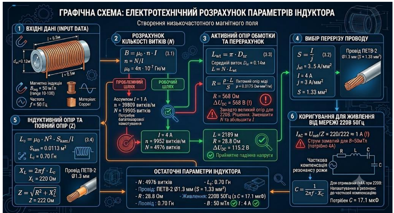
Рисунок 3.1 – Електротехнічний розрахунок параметрів індуктора
