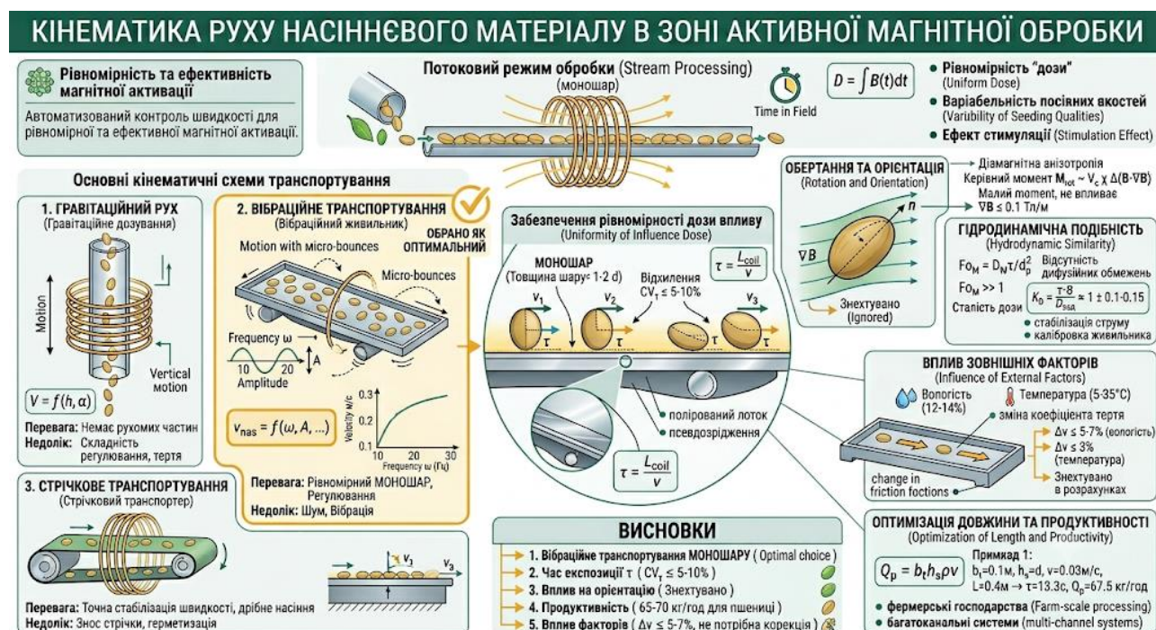
Рисунок 2.4 – Кінематика руху насінневого матеріалу в зоні активної магнітної обробки
