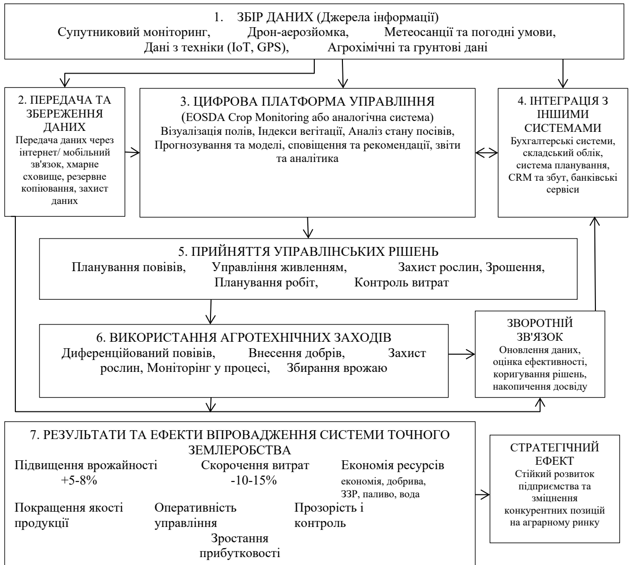
Рисунок 3.3 – Схема функціонування системи точного землеробства у ФГ «СЕРПНЕВЕ-Л»
