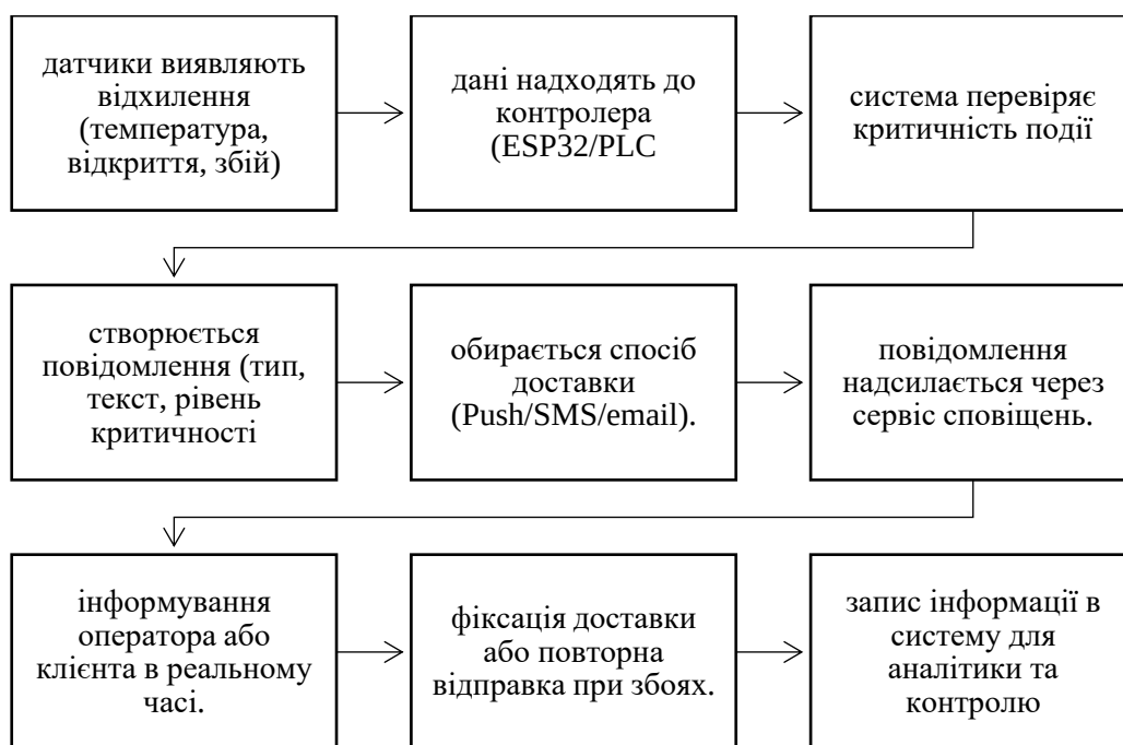
Рисунок 3.6 - Система сповіщень (Push/SMS/Email API) у смарт термопоштомотаті
