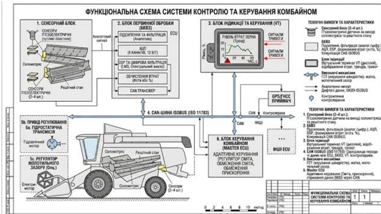
Рисунок 3.5 – Функціональна схема системи контролю та керування комбайном
