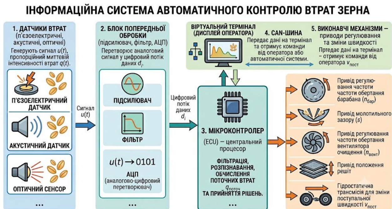
Рисунок 2.3 – Інформаційна система автоматичного контролю втрат зерна
