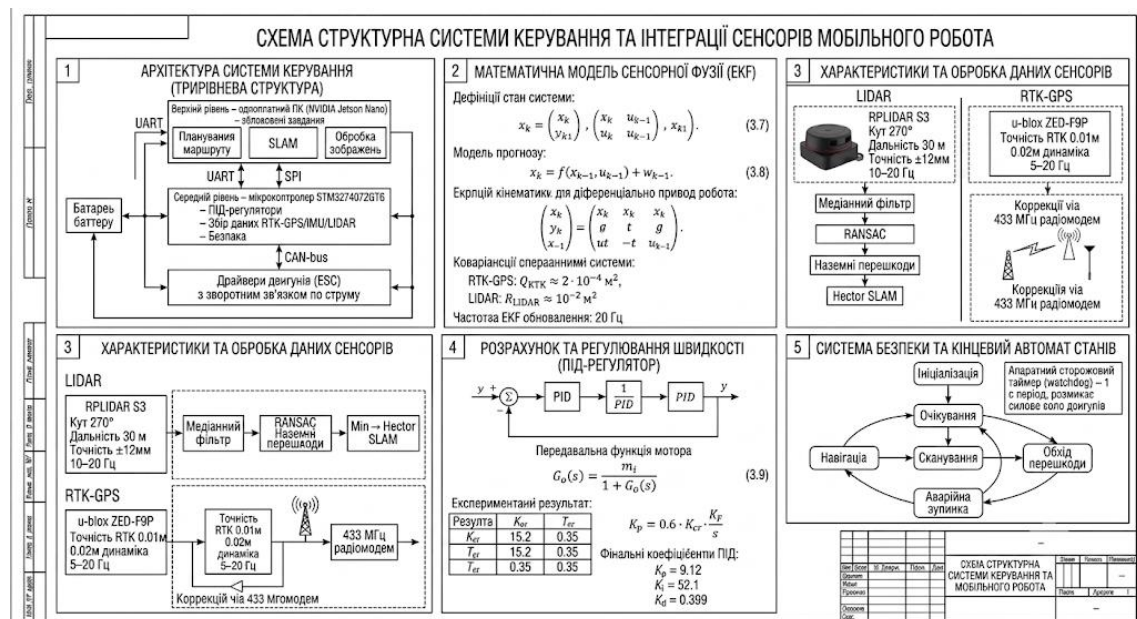
Рисунок 3.3 – Структурна схема системи керування на базі мікроконтролера та інтеграція RTK-GPS
