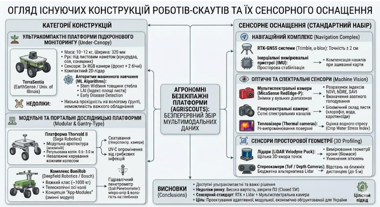
Рисунок 1.3 – Огляд існуючих конструкцій роботів-скаутів та їх сенсорного оснащення
