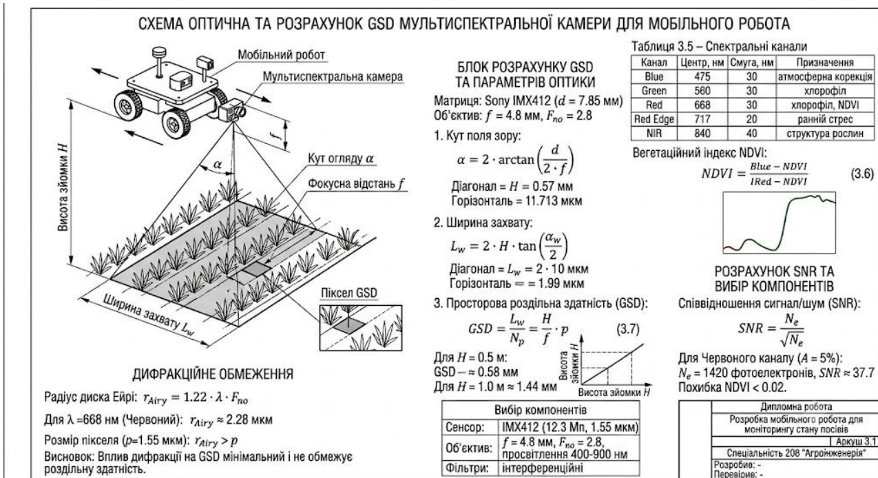
Рисунок 3.2 – Обґрунтування параметрів оптичної системи мультиспектральної камери та розрахунок просторової роздільної здатності
