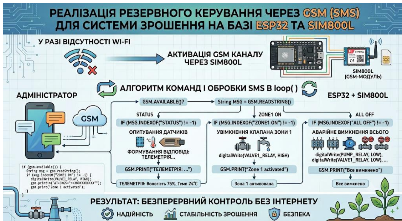
Рисунок 3.7 – Код обробки SMS вбудовується в loop():
