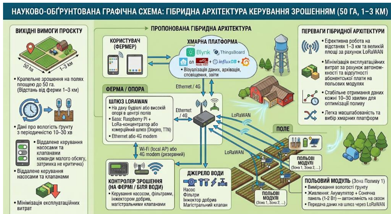
Рисунк 1.6 – Гібридна архітектура керування зрошенням
