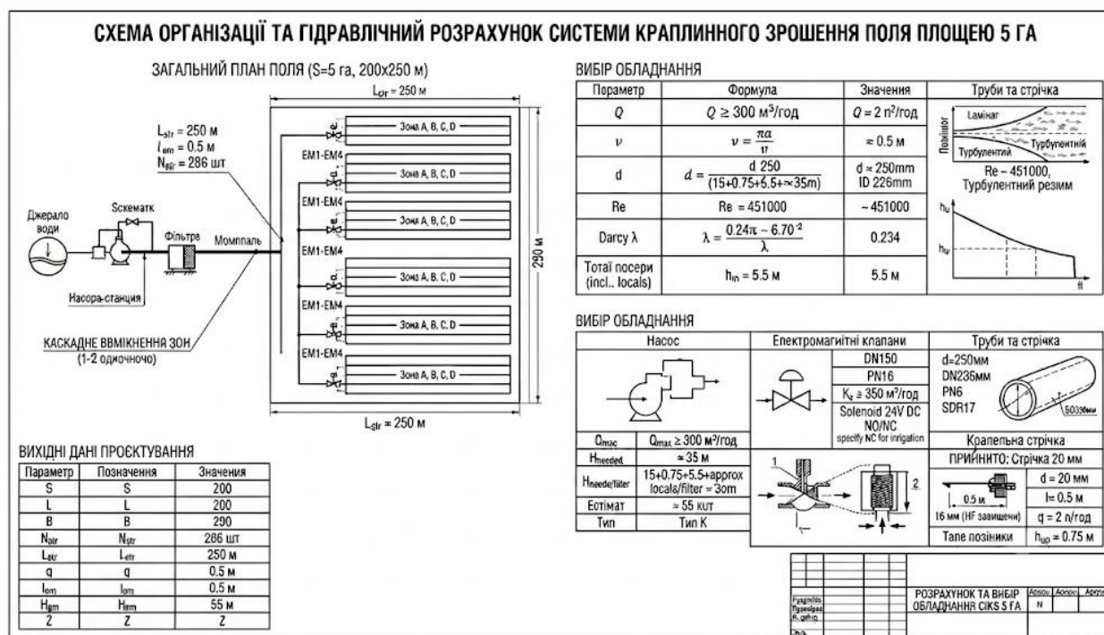
Рисунок 3.1 – Схема організації та гідрравлічний розрахунок магістрального трубопроводу
