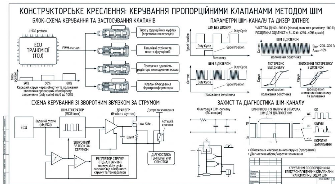
Рисунок 3.5 – Керування пропорційними клапанами методом ШІМ
