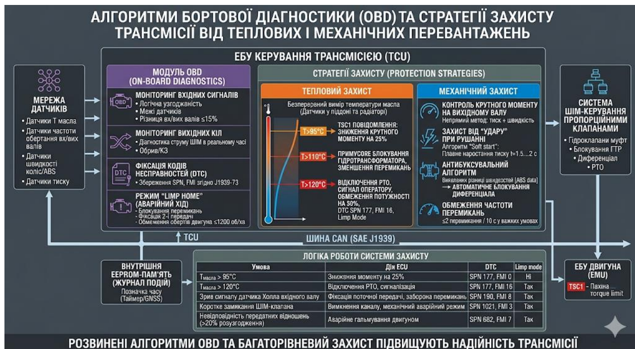
Рисунок 3.6 – Алгоритми бортової діагностики (OBD)
