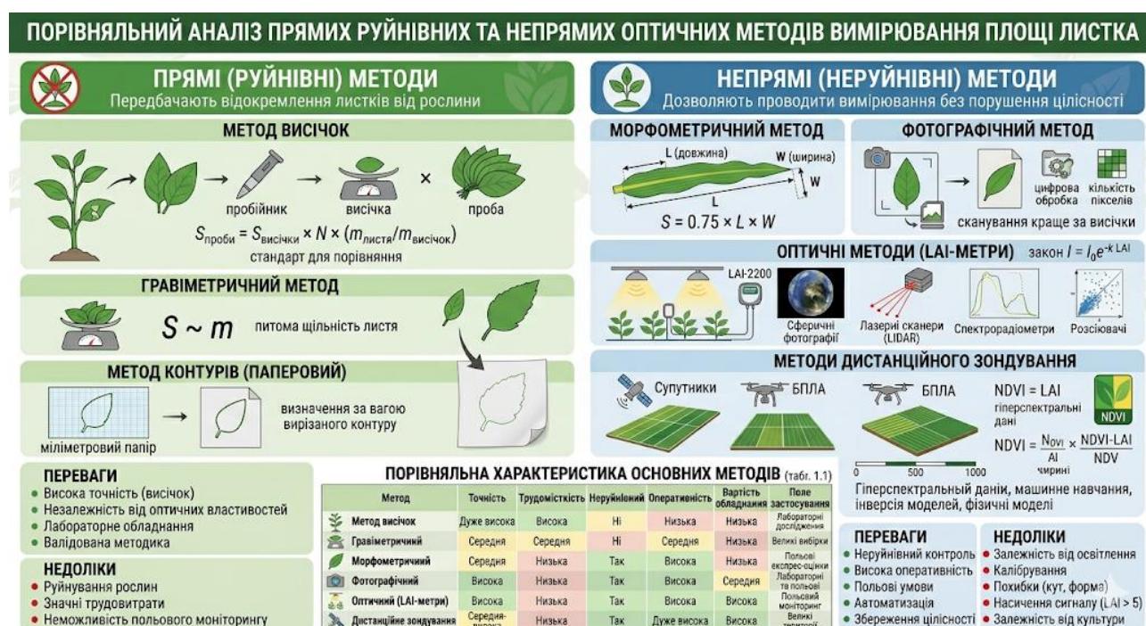
Рисунок 1.2 – Порівняльний аналіз прямих руйнівних та непрямих оптичних методів вимірювання площі листка
