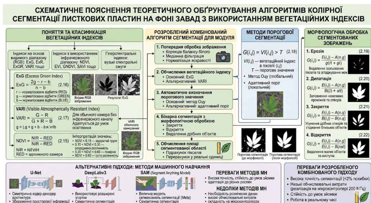
Рисунок 2.2 – Теоретичне обґрунтування алгоритмів колірної сегментації листкових пластин на фоні завад з використанням вегетаційних індексів
