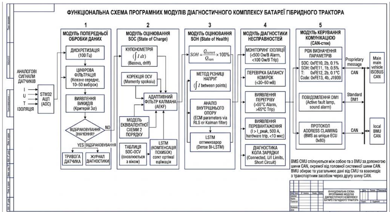
Рисунок 3.4 – Функціональна схема програмних модулів діагностичного комплексу батареї гібридного трактора
