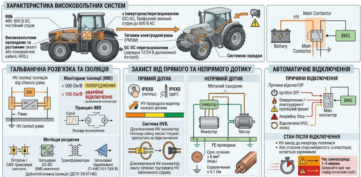
Рисунок 4.2 – Електробезпека під час роботи з високовольтними ланцюгами постійного та змінного струму
