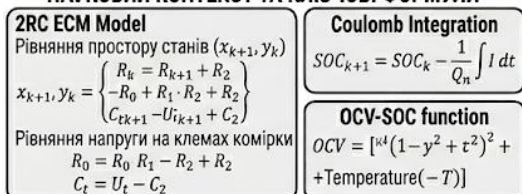
Рисунок 3.5 – Модель еквівалентної схеми другого порядку (2RC ECM) для оцінки SOC
