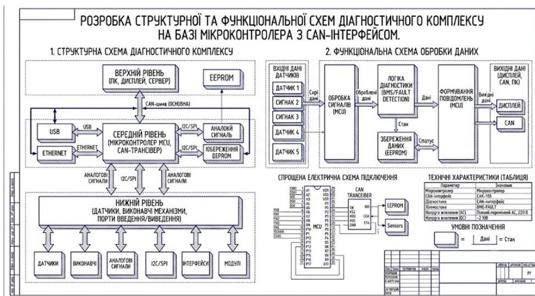
Рисунок 3.1 – Структурна та функціональна схема діагностичного комплексу на базі мікроконтролера
