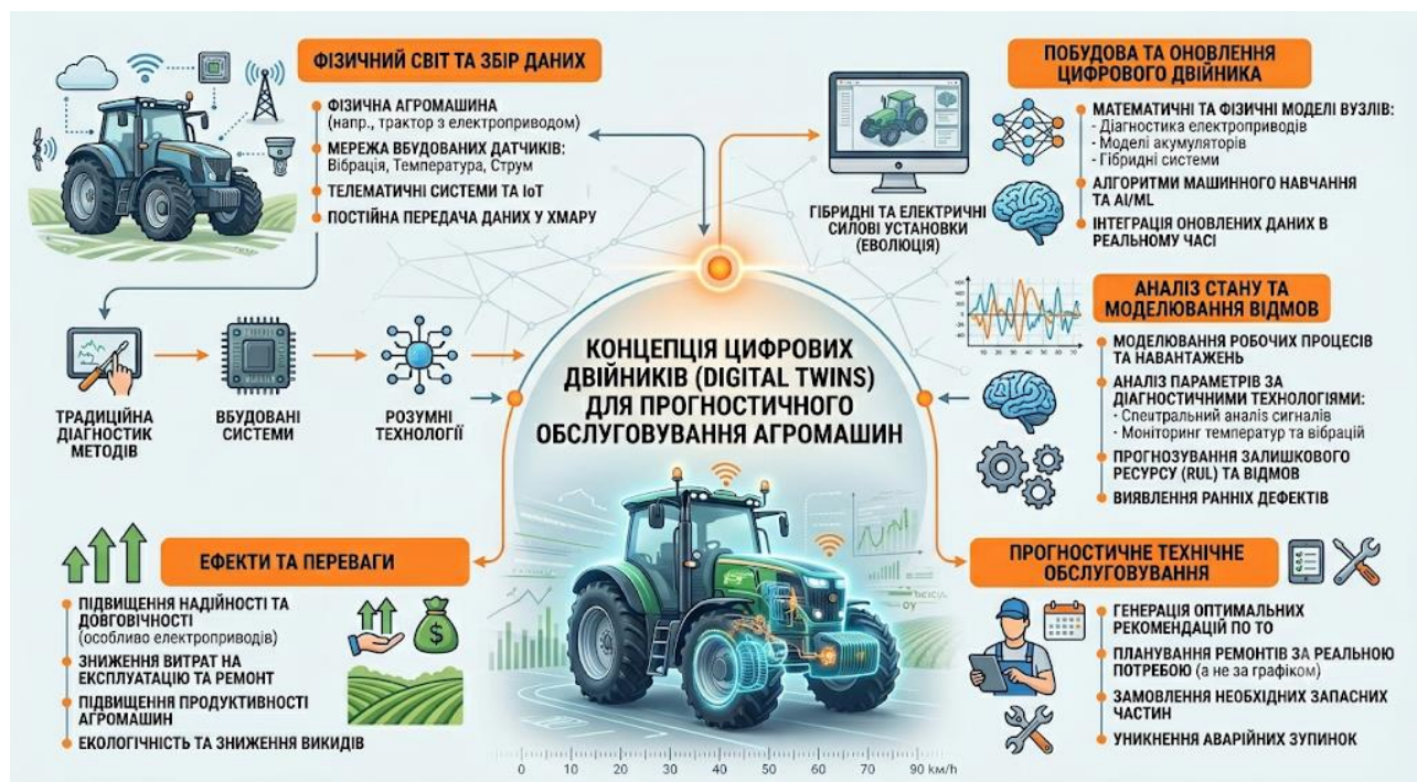
Рисунок 1.3 – Концепція цифрових двійників (Digital Twins) як інструмент прогностичного технічного обслуговування агромашин
