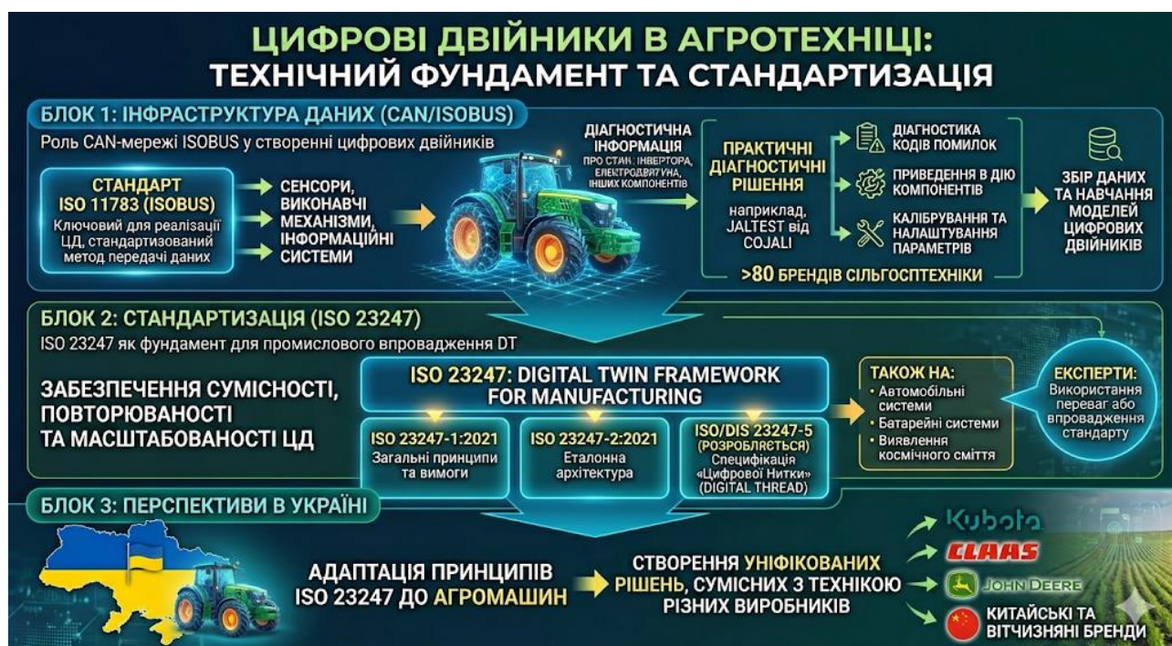
Рисунок 1.10 – Стандартизація: ISO 23247 як фундамент для промислового впровадження DT
