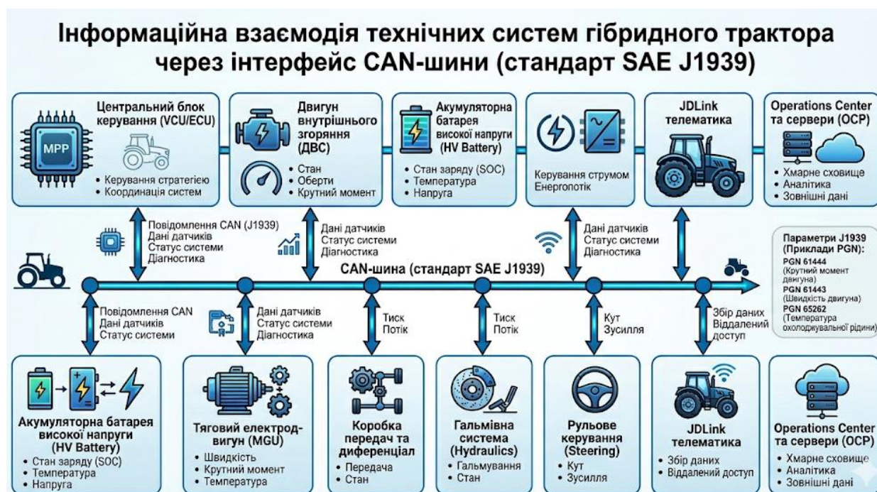
Рисунок 2.1 – Інформаційна взаємодія технічних систем гібридного трактора
