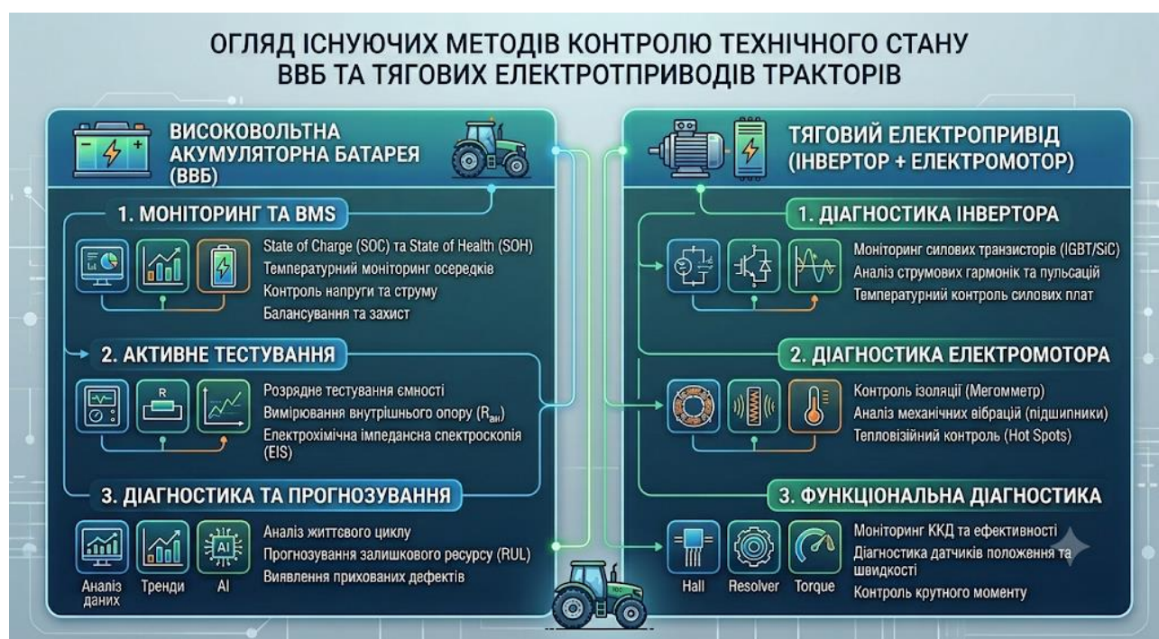
Рисунок 1.2 – Огляд існуючих методів контролю технічного стану високовольтних акумуляторних батарей (ВВБ) та тягових електроприводів тракторів
