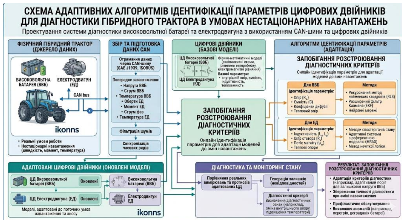
Рисунок 2.2 – Багаторівнева архітектура DMA
