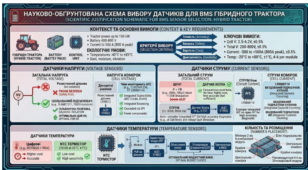
Рисунок 3.3 – Науково-обґрунтована схема вибору датчиків: датчики напруги, датчики струму, датчики температури,
