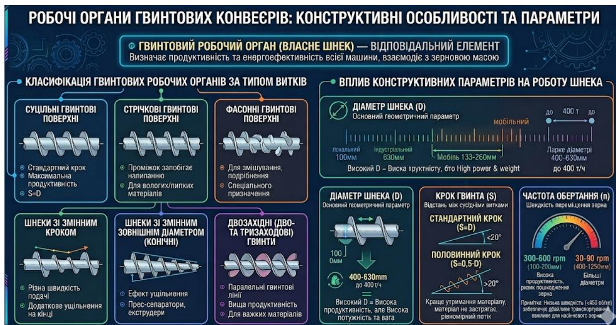
Рисунок 1.7 – Робочі органи гвинтових конвеєрів: конструктивні особливості та параметри
