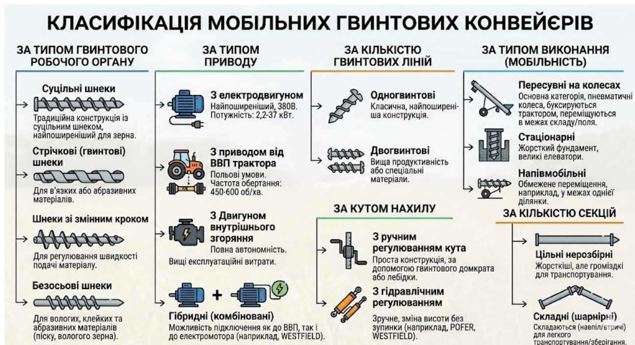
Рисунок 1.6 – Класифікація мобільних гвинтових конвеєрів
