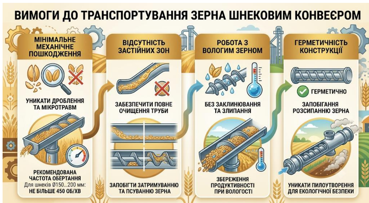
Рисунок 2.2 – Вимоги до транспортування зерна шнековим конвеєром
