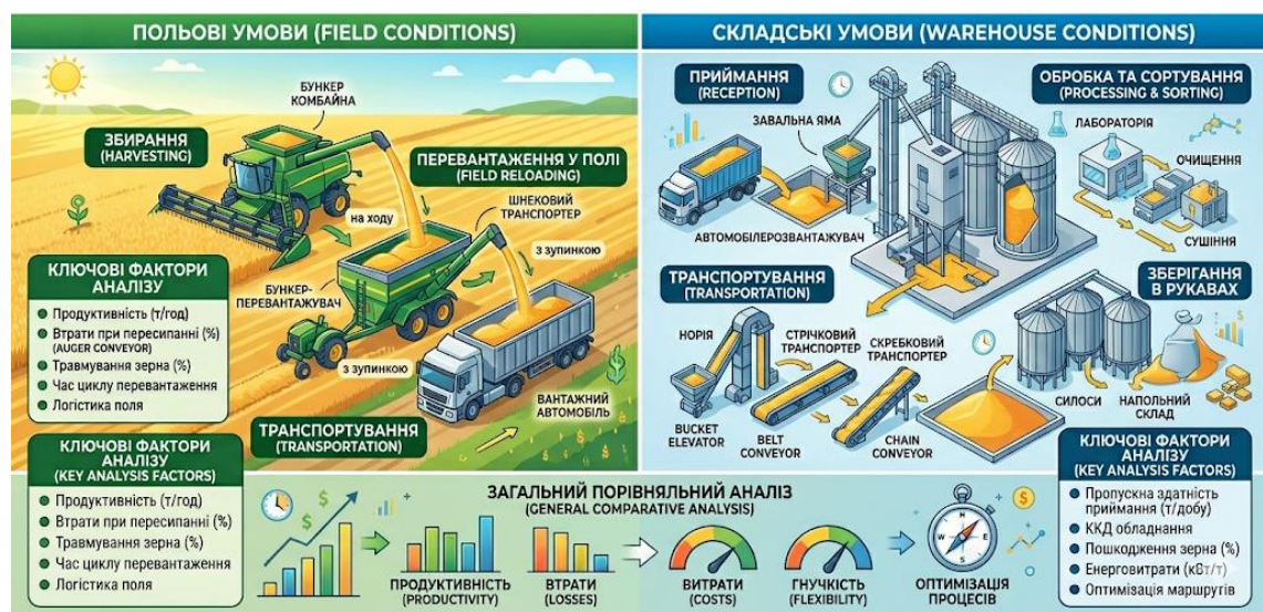
Рисунок 1.1 – Аналіз технологічних процесів перевантаження зернової маси: польові та складські умови
