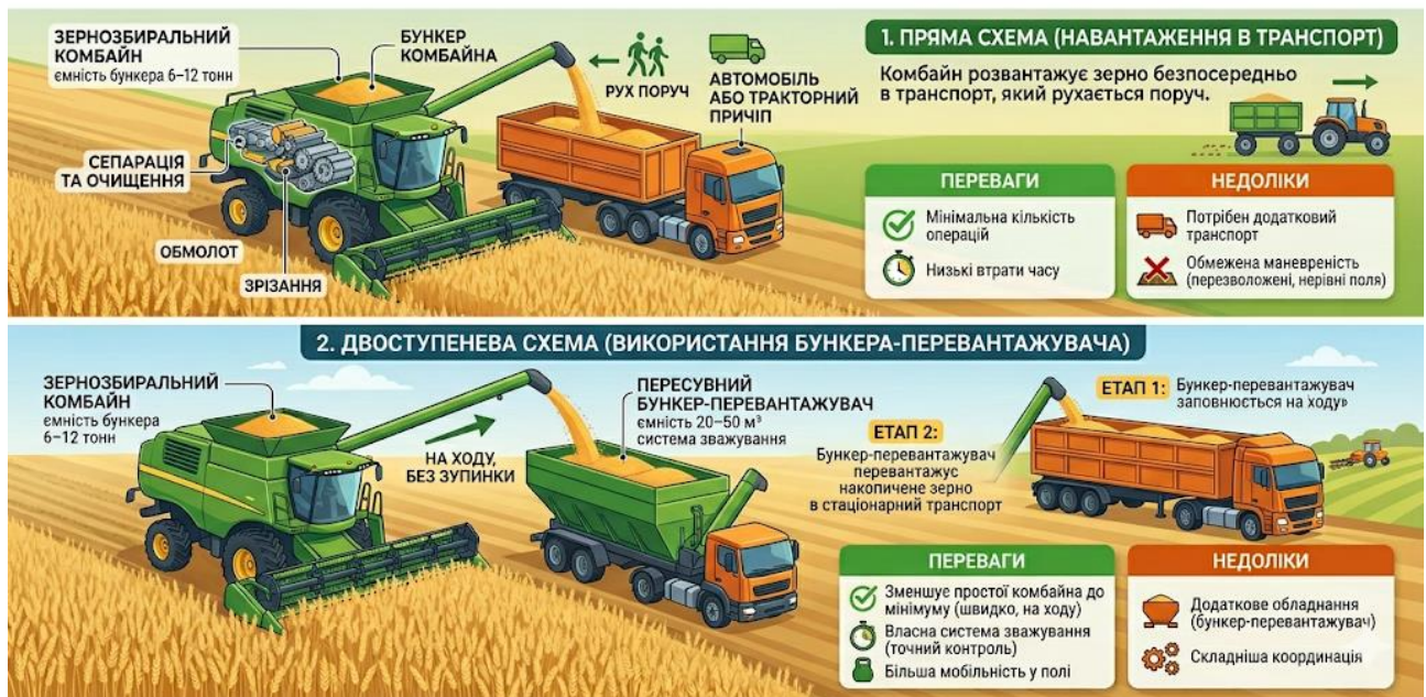
Рисунок 1.3 – Організація польового перевантаження зерна
