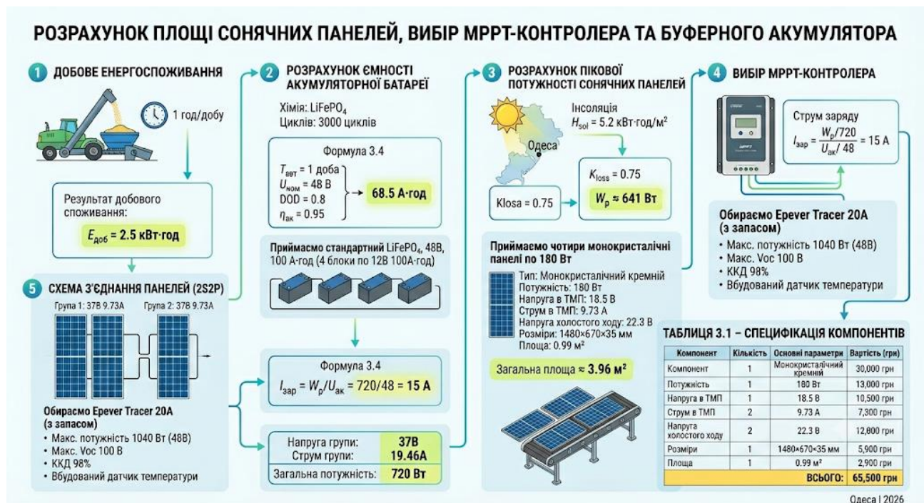
Рисунок 3.2 – Розрахунок площі сонячних панелей, вибір МРРТ-контролера та буферно акумулятора
