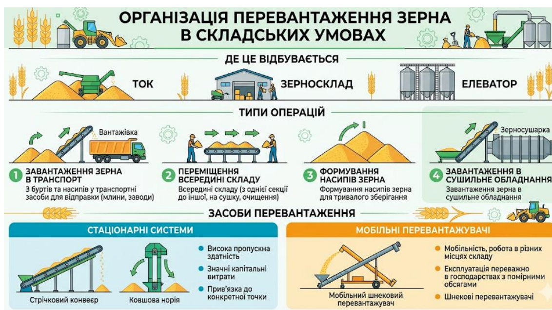
Рисунок 1.4 – Організація перевантаження зерна в складських умовах
