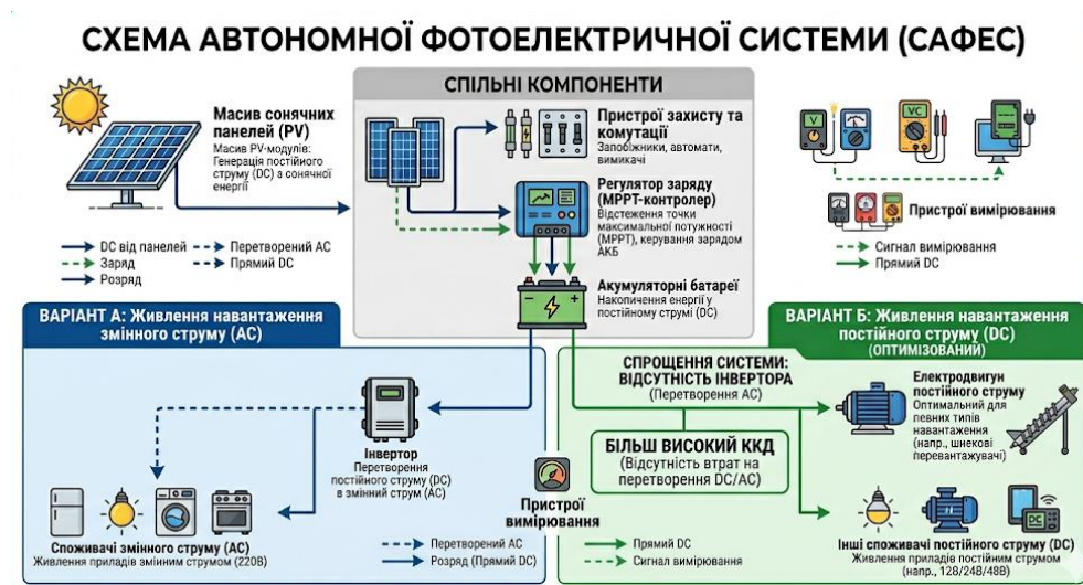
Рисунок 1.9 – Схема автономної фотоелектричної системи
