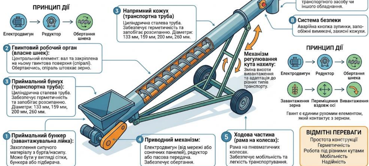
Рисунок 1.5 – Конструкція мобільного гвинтового конвеєра та його робочих органів
