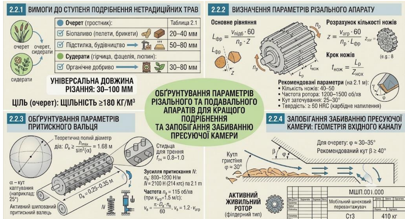
Рисунок 2.2 – Обґрунтування параметрів різального та подавального апаратів для кращого подрібнення та запобігання забиванню пресуючої камери
