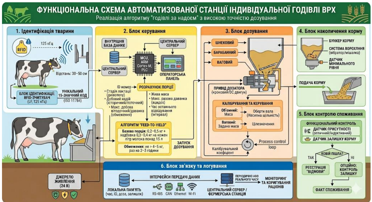
Рисунок 2.2 – Функціональна схема автоматизованої станції індивідуальної годівлі ВРХ
