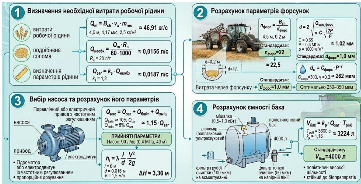
Рисунок 3.2 – Розрахунок гідравлічної системи подачі біопрепарату
