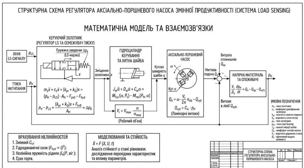
Рисунок 2.3 – Структурна схема регулятора аксіально-поршневого насоса
