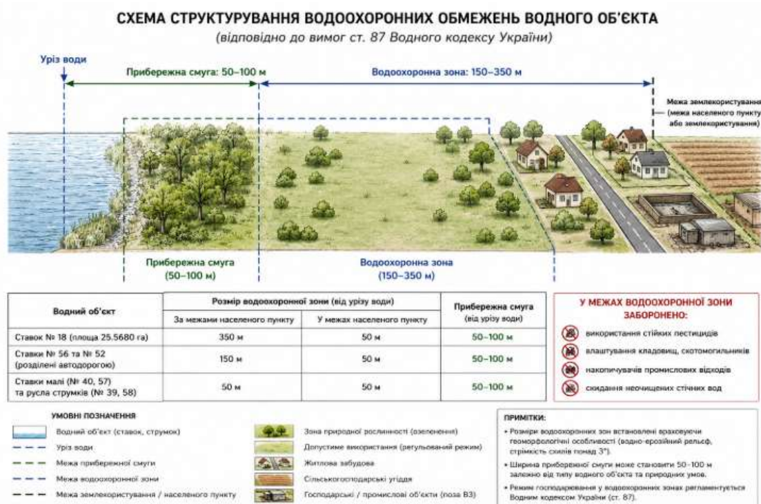
Рис. 4.2.18 – Схема структурування водоохоронних обмежень водного об'єкта
