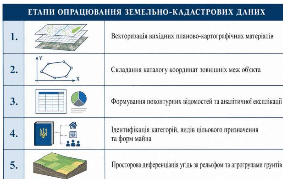
Рис. 3.1. - Технологічна схема підготовки земельно-кадастрових даних для внесення відомостей до Державного земельного кадастру*
