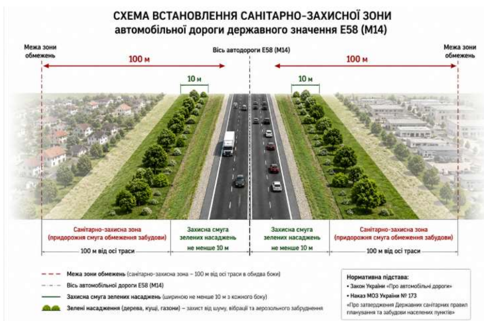
Рис. 4.2.12 – Схема встановлення санітарно-захисної зони автомобільної дороги державного значення
