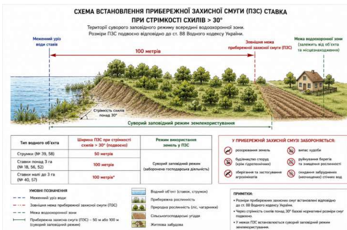
Рис. 4.2.20 – Схема встановлення прибережної захисної смуги ставка при стрімкості схилів > 30^\circ
