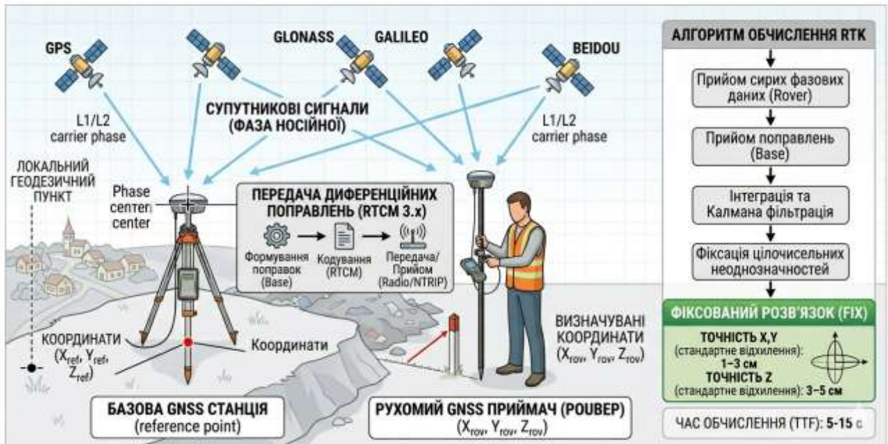
Рисунок 2.4 - Схема GNSS спостережень у режимі РТК
