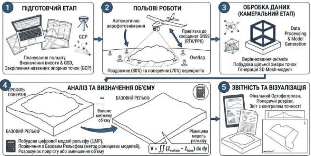
Рисунок 2.6 - Технологія зйомки БПЛА для визначення об'ємів сміттєзвалища
