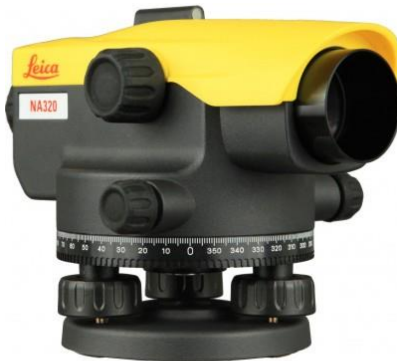
Рисунок 3.6 – Загальний вигляд нівеліра Leica NA324
