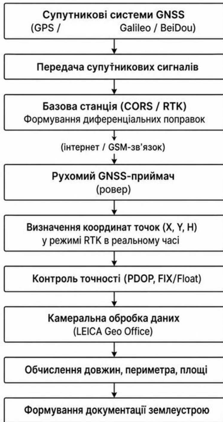
Рисунок 3.3 – Схема технологічного процесу GNSS-вимірювань із застосуванням мережевої RTK-технології (Network RTK)
