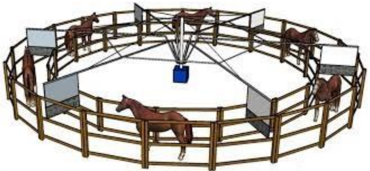
Рис. 3.5. Принцип дії електромеханічної водилки
