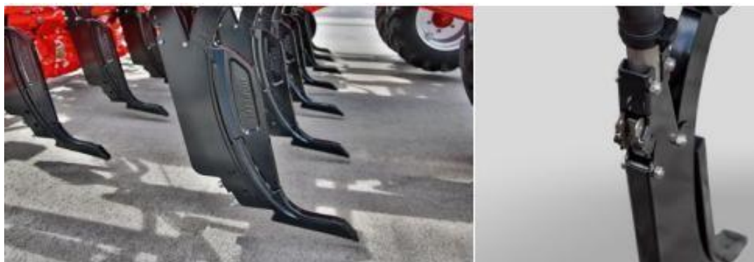
Рисунок 2.7 – Розпушувальні лапи-стійки з патрубком подачі добрив
