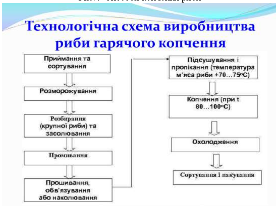
Рис. 5. Технологічна схема виробництва риби гарячого копчення
