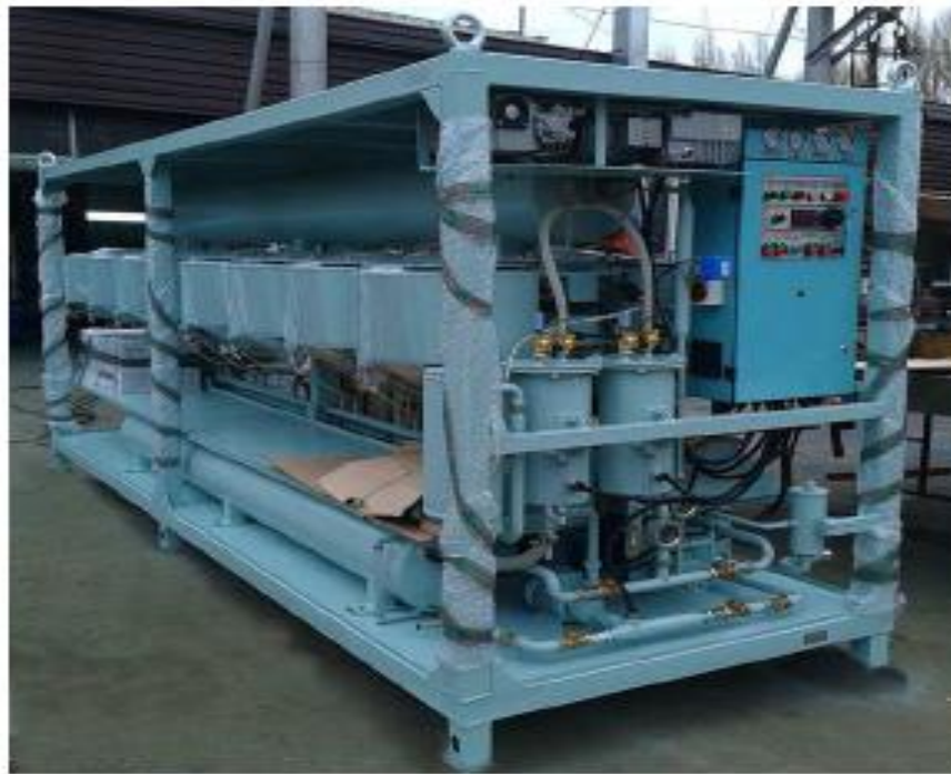
Рис. 1.10 – Встановлення вакуумної регенерації УВР – 0,1.
