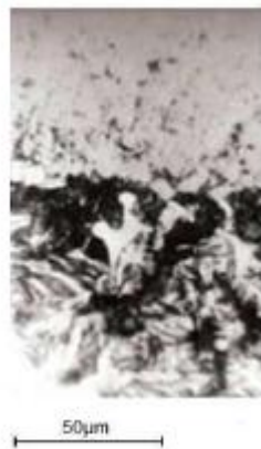
Рис. 3.9 – Мікроструктура зони розчинно-дифузійної взаємодії твердого сплаву ВК8 та FeC-припою ( \times 1200 ).
