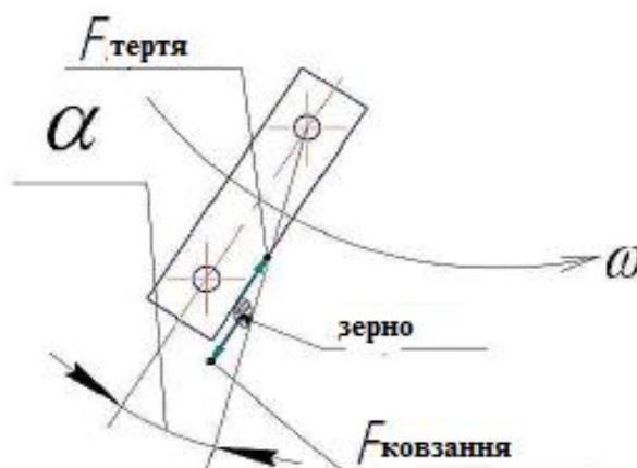
Рис. 1.4. – Схема впливу сил тертя на робочу поверхню молотка при зіткненні з часткою матеріалу.
