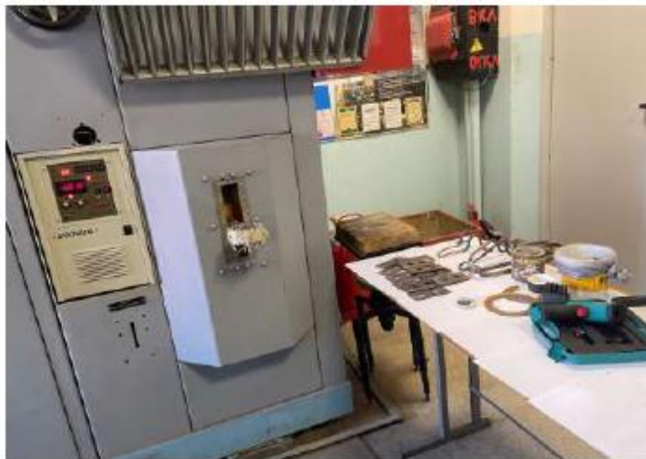
Рис. 3.1 – Устаткування для паяння зміцнених молотків.
