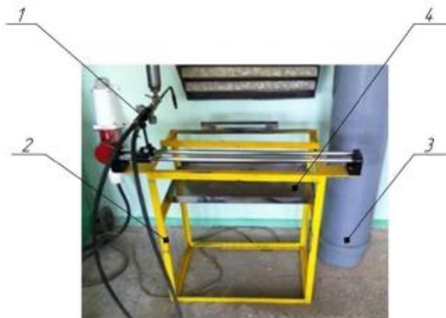
Рис. 2.13. – Встановлення газополум'яного наплавлення : 1 - пальник наплавної моделі Euro Jet XS-8; 2 – каркас установки; 3 - пропанобутанова суміш; 4 – лоток.
