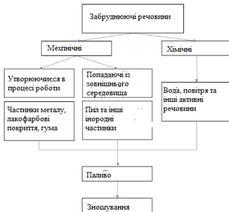
Рис. 1.4. Характеристика забруднюючих речовин, що веде до зношування прецизійних поверхонь.
