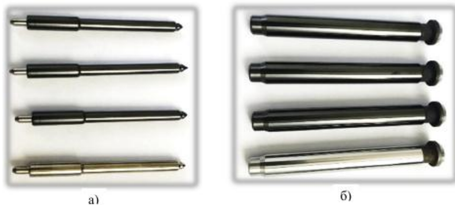
Рису. 1.11. Вуглець – алмазні покриття (DLC): а – голка розпилювача форсунки АЗП; б – плунжери ПНВТ.
