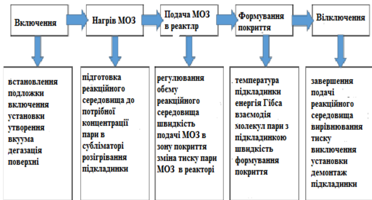
Рис. 3.4. Схема технологічного процесу формування зносостійкого покриття деталей.
