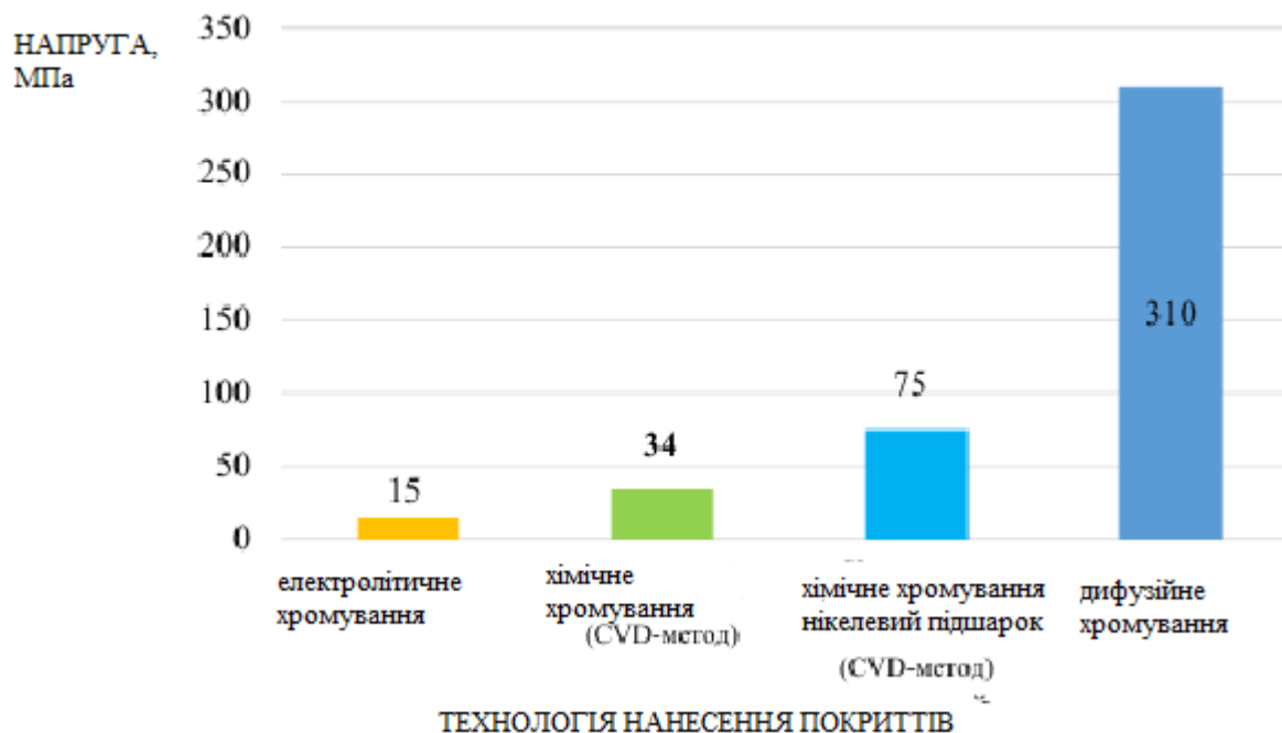
Рис. 3.14. Порівняльна оцінка адгезії хромових покриттів за різних способів відновлення поверхонь.
