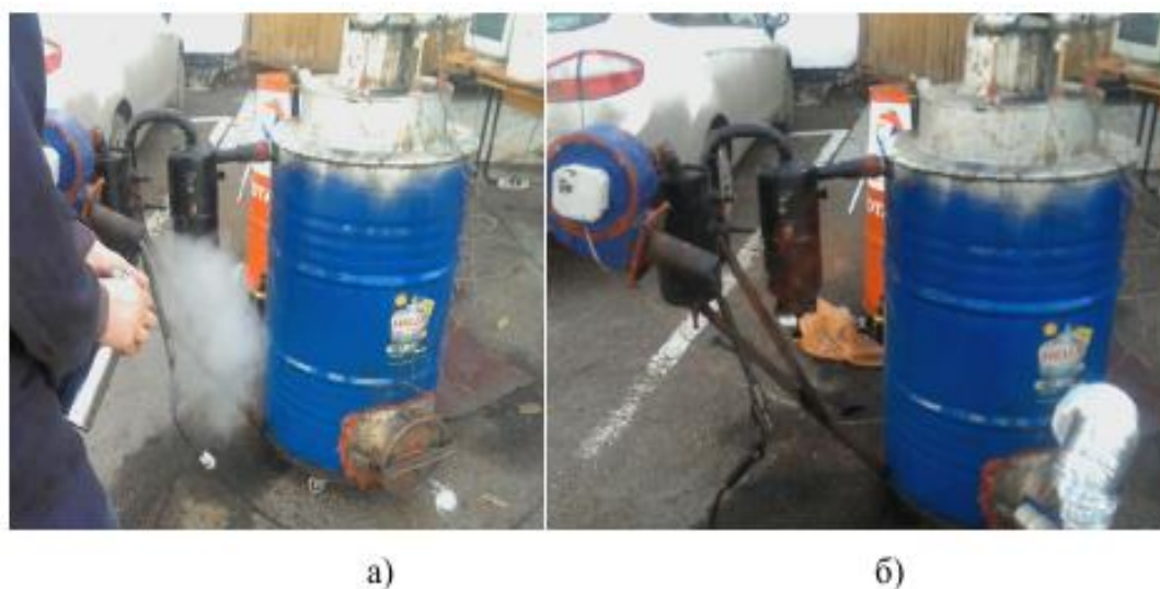
Рис. 3.3. Запалення генераторного газу: а) до займання; б) після займання.
