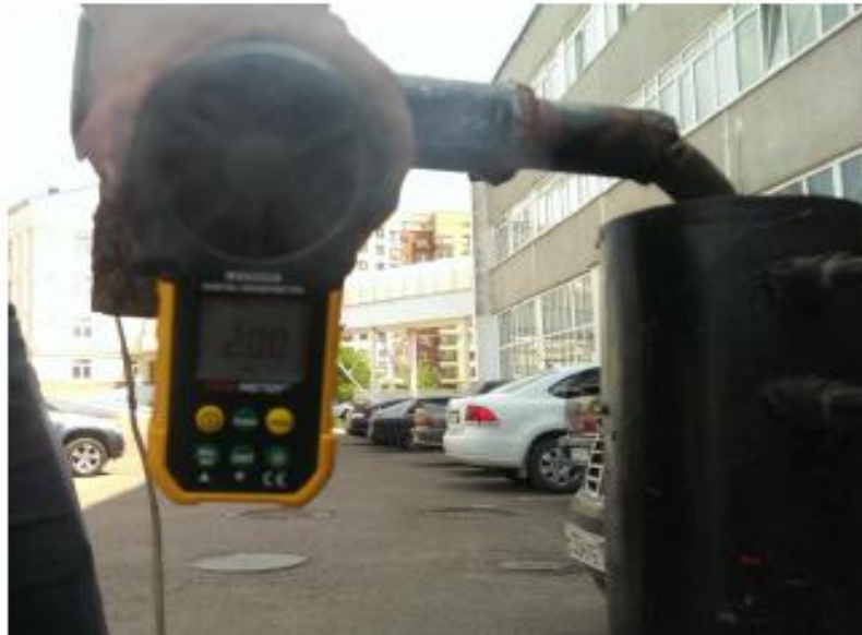
Рис. 3.8 - Визначення швидкості потоку газу на виході з розгінного вентилятора.
