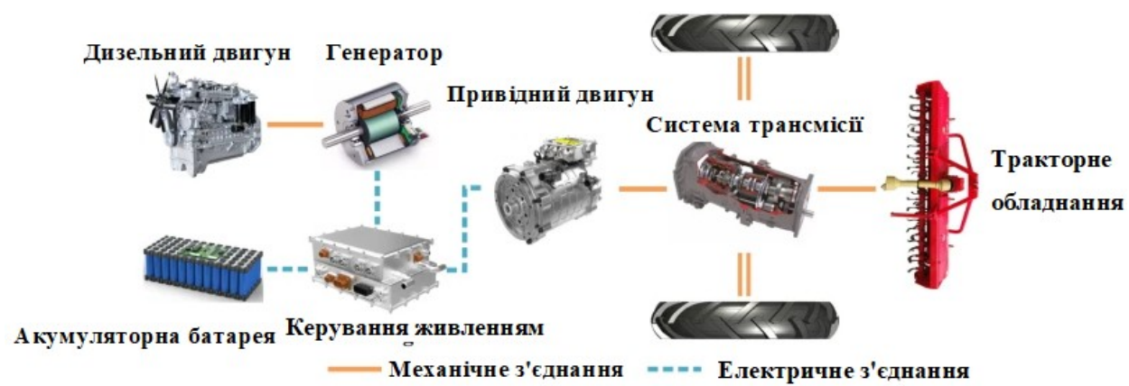
Рисунок 1.1 – Структура системи живлення трактора
