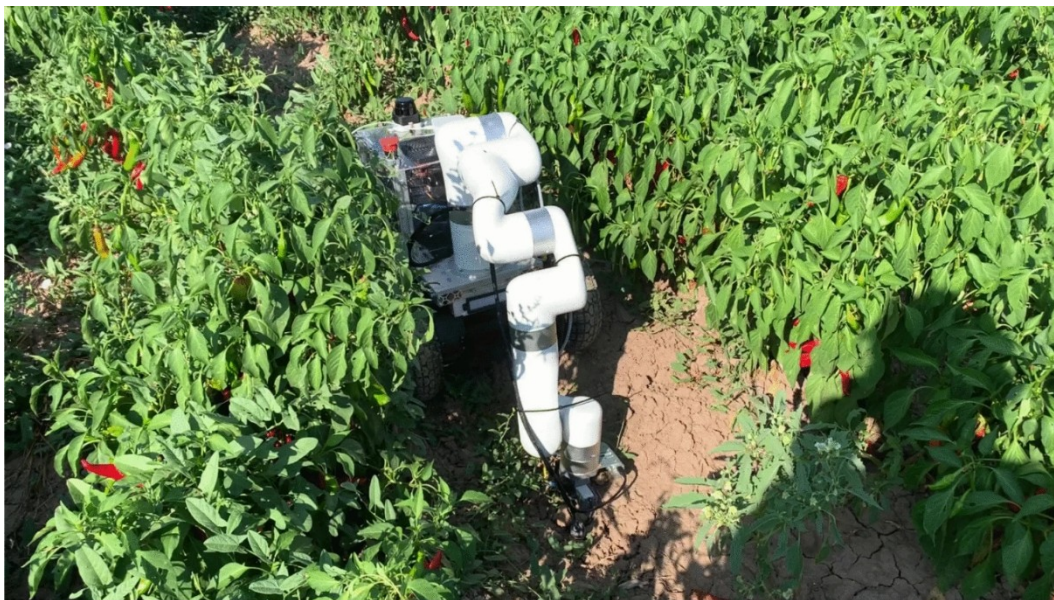
Рисунок 3.3 – Роботизована система, що виконує вимірювання ґрунту
