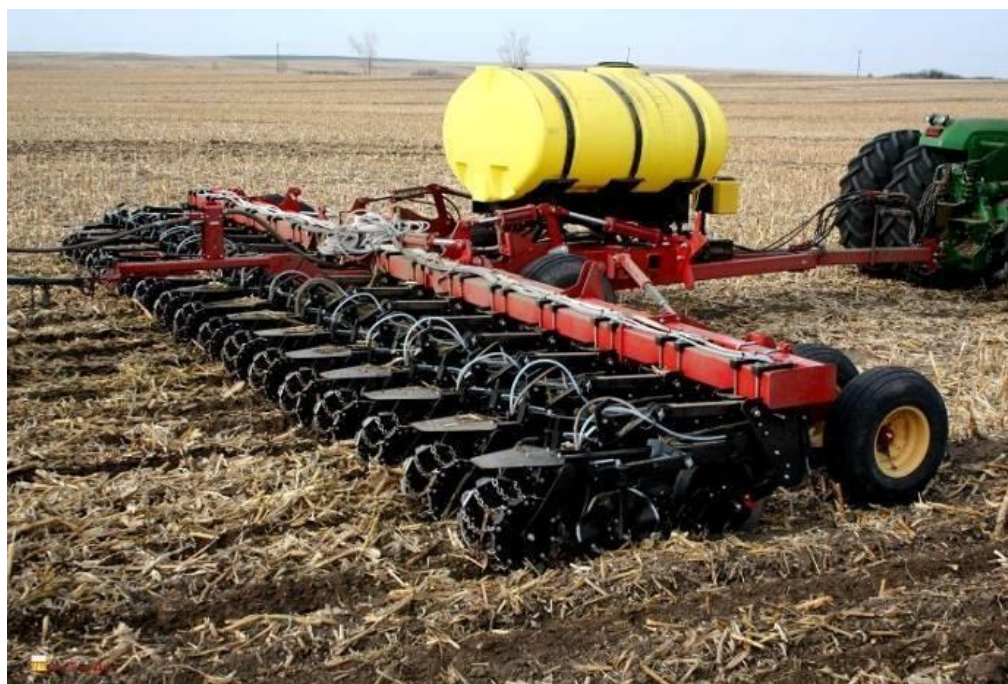
Рис. 1.4. Передпосівний обробіток ґрунту, з одночасним внесенням хімічних речовин.
