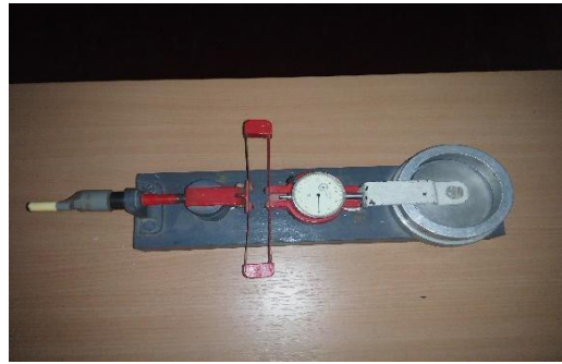
Рис. 2.3. Конструкційна схема а) та загальний вид б) зсувного приладу: 1 – обойма нерухома; 2 – обойма рухома; 3 – кришка; 4 – відтарований пружний елемент; 5 – упор; 6 – мікрометр.
