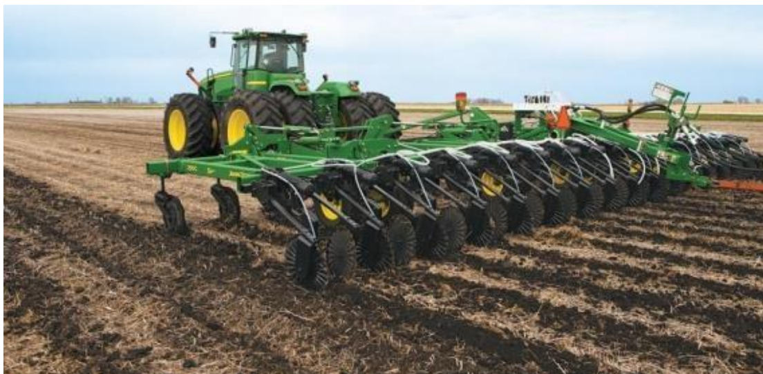
Рис. 1.3. Смоговий обробіток ґрунту по стерні.
