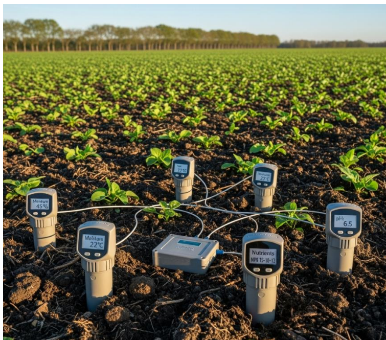
Рисунок 2.3 – Ґрунтові датчики, розміщені в полі, забезпечують вимірювання рівня вологості, температури, вмісту поживних речовин та рН у режимі реального часу
