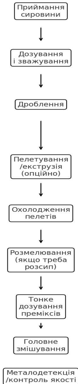
Рисунок 3.3- Розширена лінія (з пелетуванням, екструзією та контролем)
