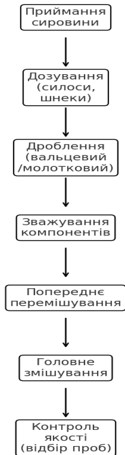
Рисунок 3.2-Технологічна послідовність виготовлення розсипних комбикормів для свиней.
