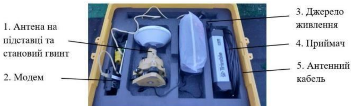
Рис. 1.2. Скомплектована мобільна базова станція
