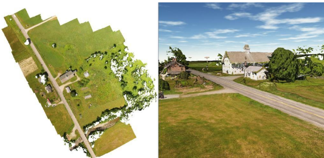
Рис.3.1. Візуалізація тривимірної хмари точок, згенеровану з пікселів у точки з можливістю експортувати в будь-який підтримуваний формат хмари точок
