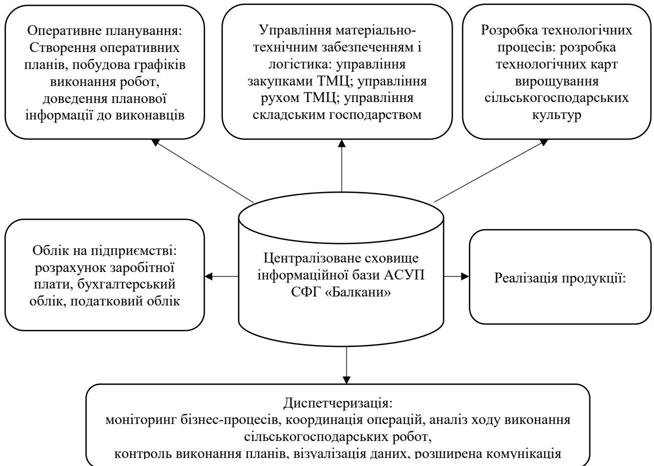
Рисунок 3.6 - Укрупнена структура автоматизованої системи управління (АСУ) СФГ «Балкани»
