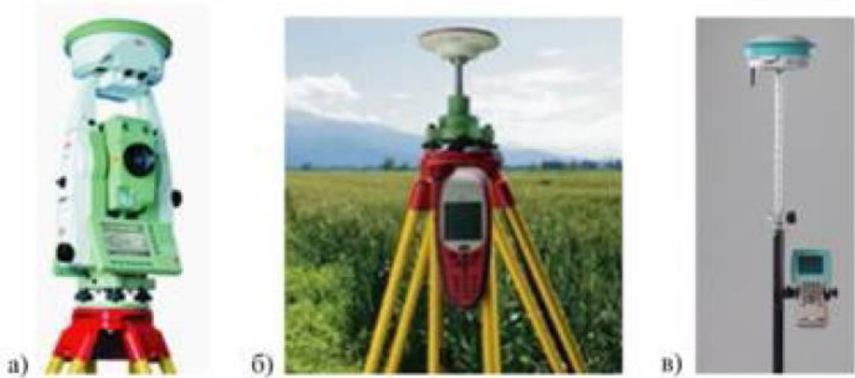
Рис. 3.5. Супутникові приймачі: а) електронний тахеометр з інтегрованим GNSS-приймачем; б) потужний GPS-приймач; в) двочастотний приймач сигналів GPS и ГЛОНАСС
