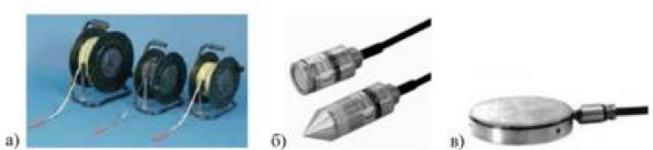
Рис. 3. 7. Вимірювачі рівня води: а) вимірювач рівня ґрунтових вод у стояках та колодязях; б) датчики порового тиску води в ґрунті; в) датчик тиску у ґрунті, рівня підземних вод
