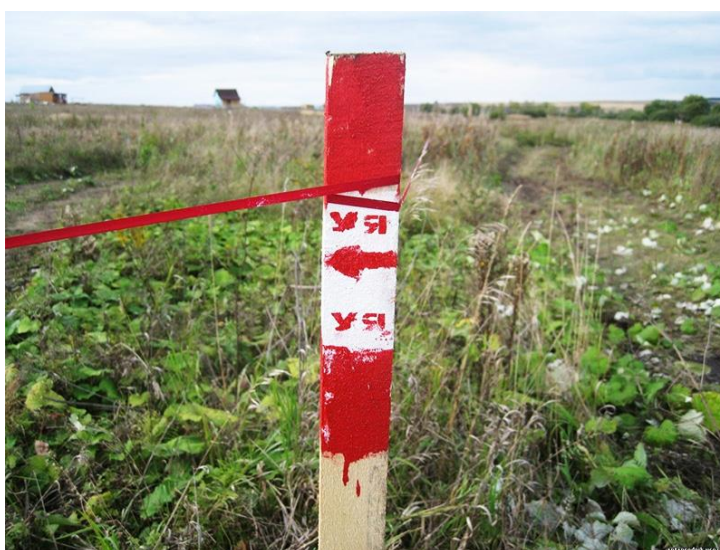
Рисунок 2.15 – Межовий знак – дерев'яний
