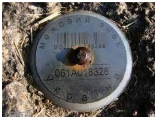
Рисунок 2.13 – Межовий знак спеціальної конструкції
