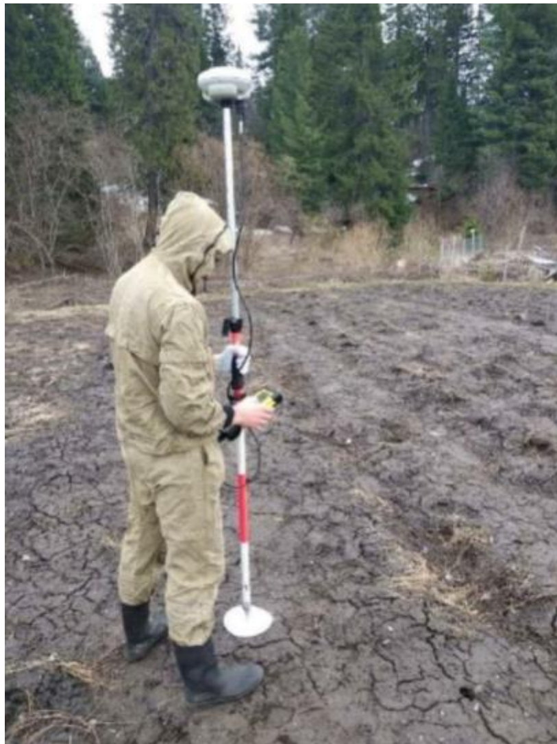
Рис. 2.7. Визначення точних координат контрольних точок
