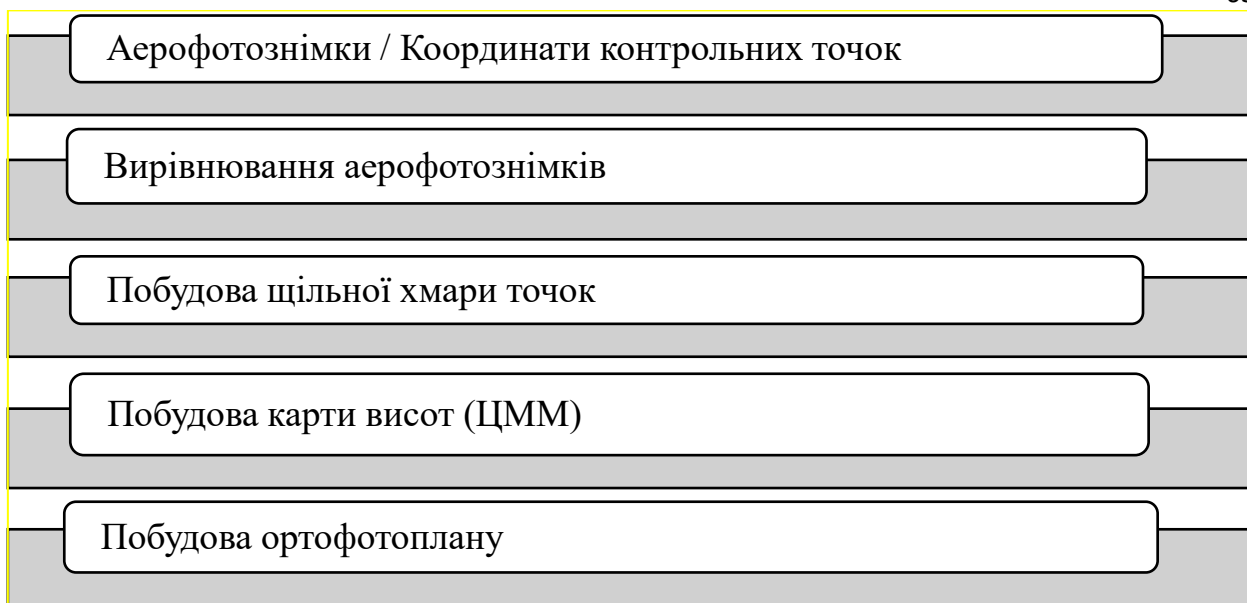
Рис. 3.5. Технологічна схема методики опрацювання результатів аерофотозйомки
