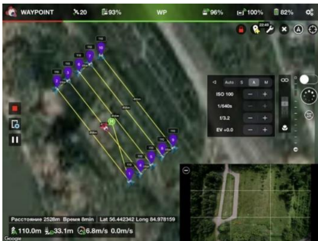
Рис. 2. 12. Налаштування параметрів експозиції телевізійної камери БПЛА
