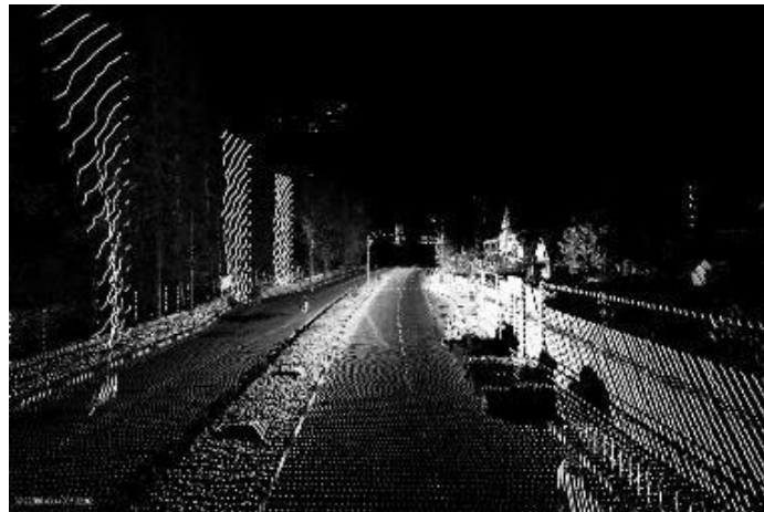
Рис. 2 Результати сканування у вигляді хмари точок
