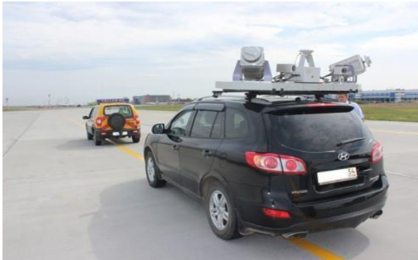
Рис. 5 Виконання зйомки мобільним лазерним сканувальним пристроєм
