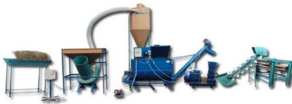
Рис. 3.4 Напівавтоматизована лінія гранулювання кормів від компанії ТОВ «Артмаш»
