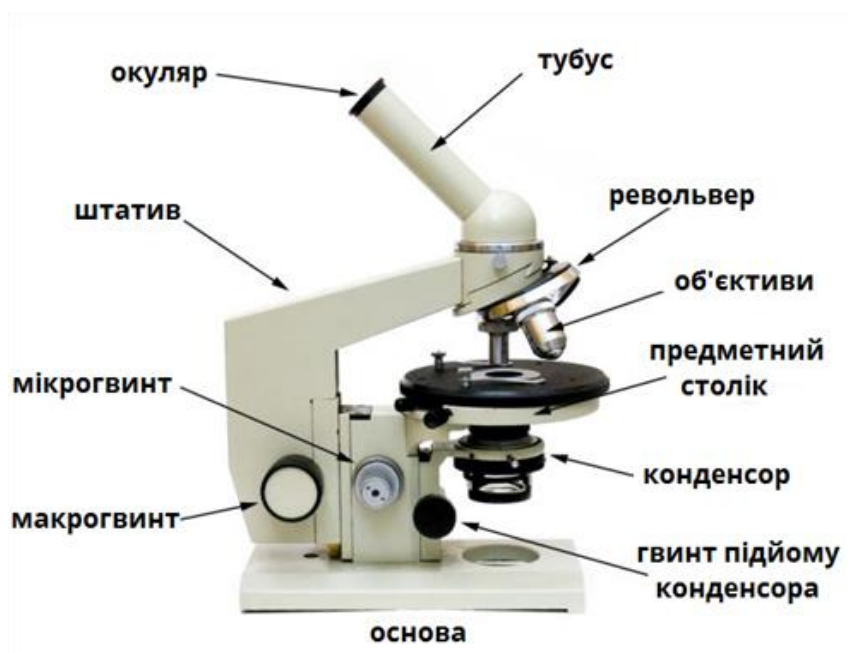
Рис.1 – Будова світлового мікроскопа
