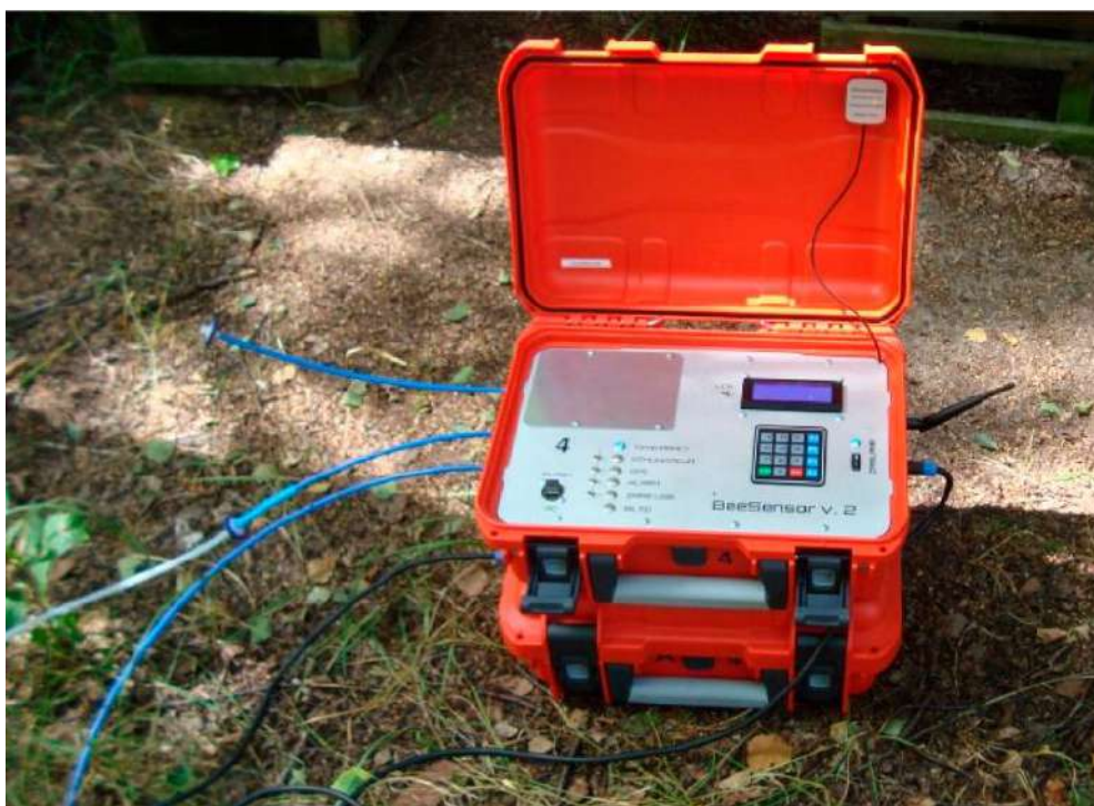
Рис. 3.6. Газовий аналізатор, який використовувався науковцями для відбору проб вуликового повітря (Szczurek and Maciejewska, 2021)
