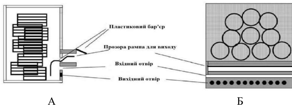
Рис. 3.12. Схема роботи дозатора для осмій (вид збоку (А) і спереду (Б) дозатора, встановленого на гніздовому укритті осмій) (Массаніані et. al., 2004).
