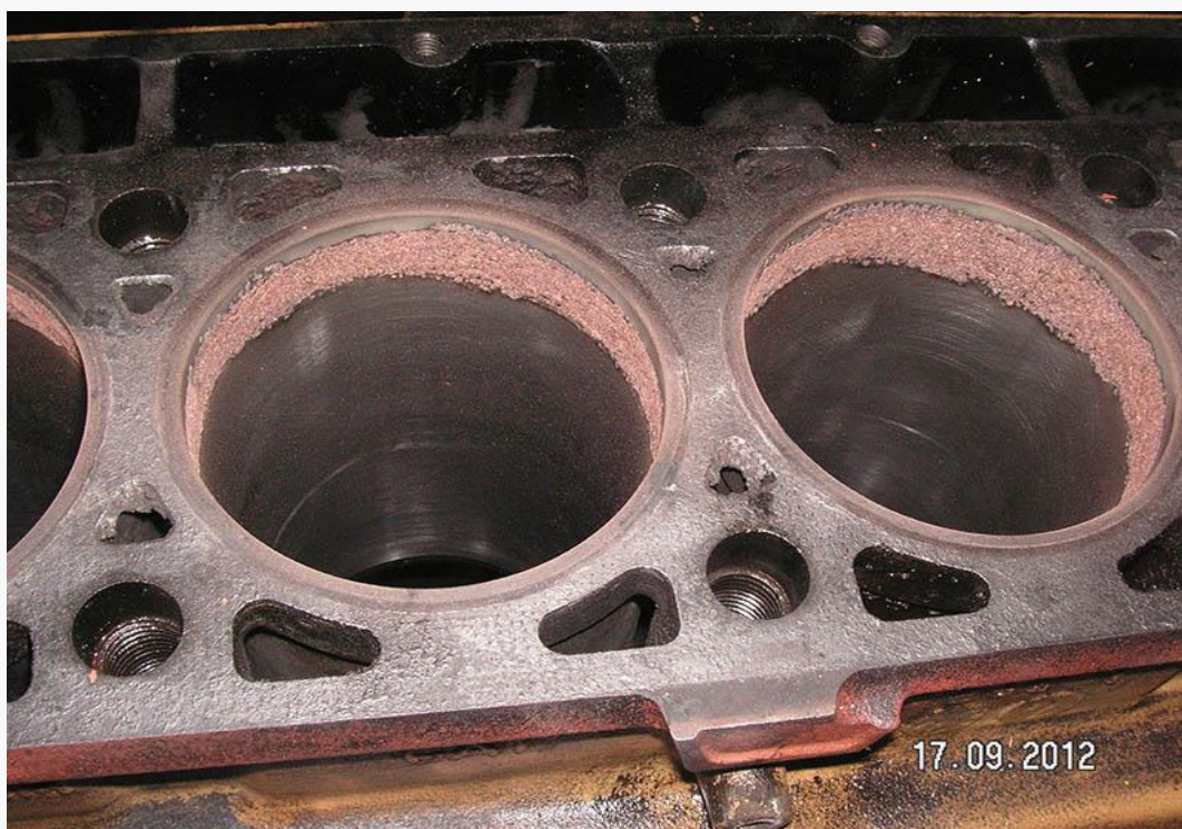
Рис. 3.15. Гільзи циліндрів двигуна після відновлення методом ЕІЛ (без механічної обробки).
