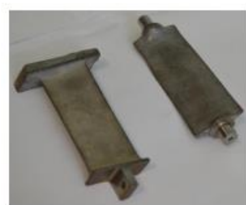
Рис. 4.4. Лопатки турбореактивного двигуна із титанових сплавів.
