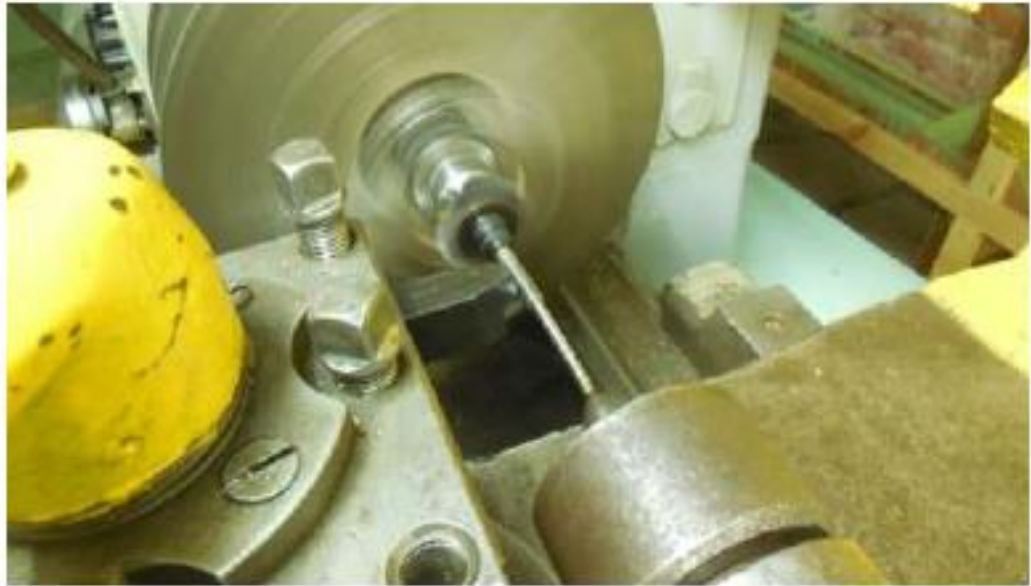
Рис. 3.11. Вигладжування поверхні вала після електроіскрової обробки.
