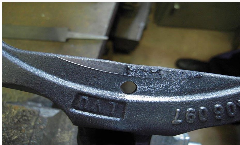
Рис. 3.18. Відновлена ділянка чавунної вилки.
