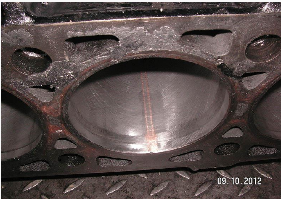
Рис. 3.17. Усунення в гільзі циліндра двигуна 6 дефекту у вигляді глибокої подряпини відновлення процесів методом ЕІЛ (після мехобробки).
