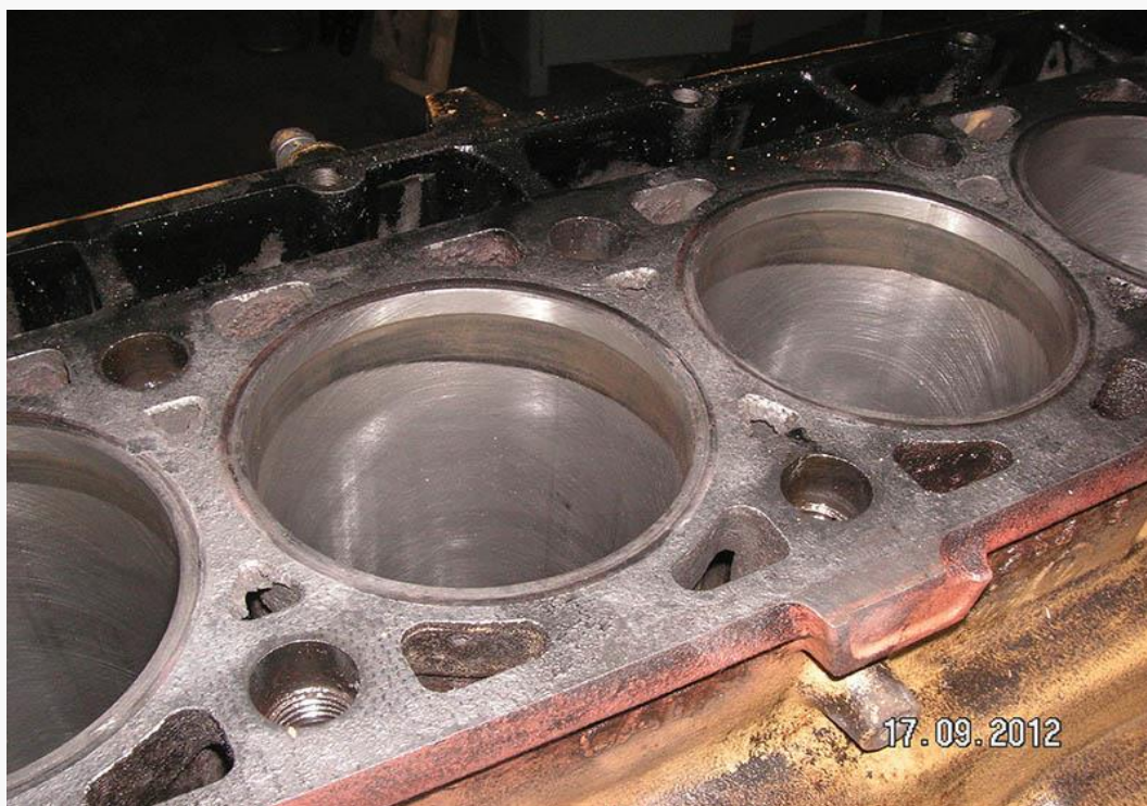
Рис. 3.14. Зношені гільзи циліндрів двигуна.
