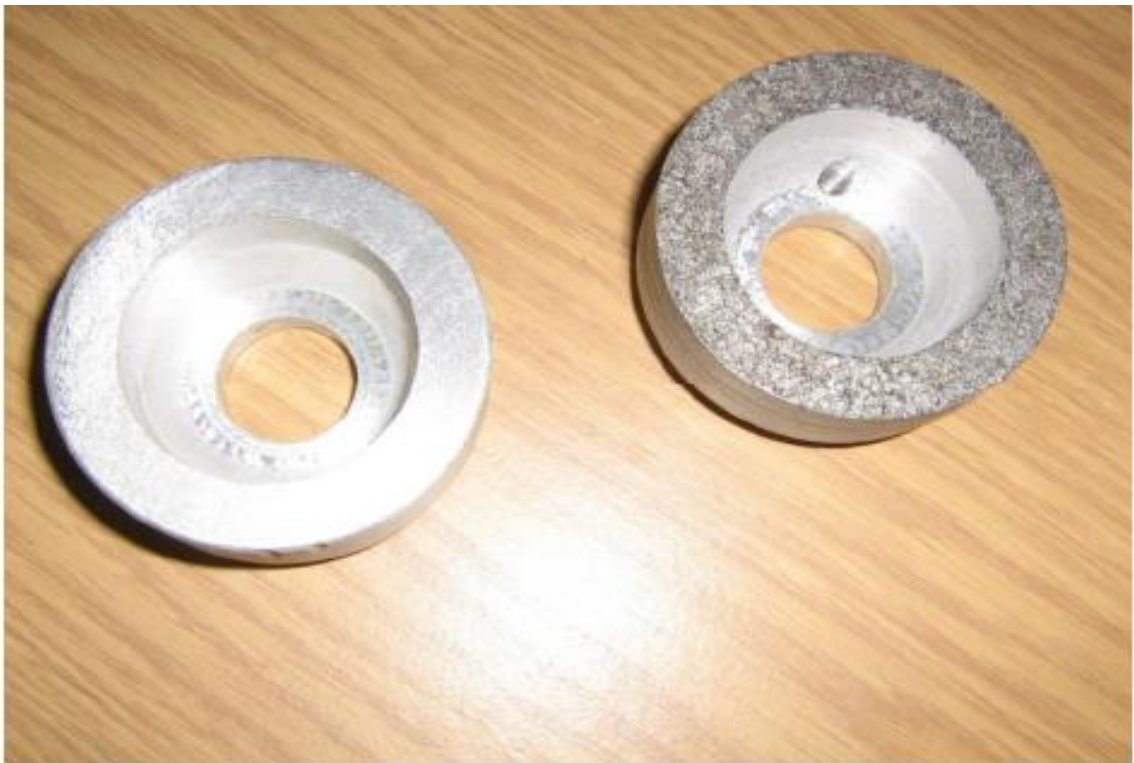
Рис 3.20. Диски із сплаву Д1 із нанесеним покриттям.
