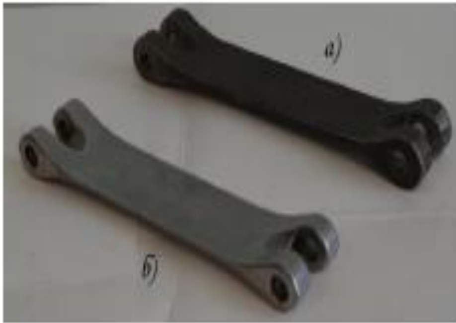
Рис. 4.5. Стяжні стрічки: а – заготівля для електрохімічної розмірної обробки; б – деталь після обробки полотна деталі.
