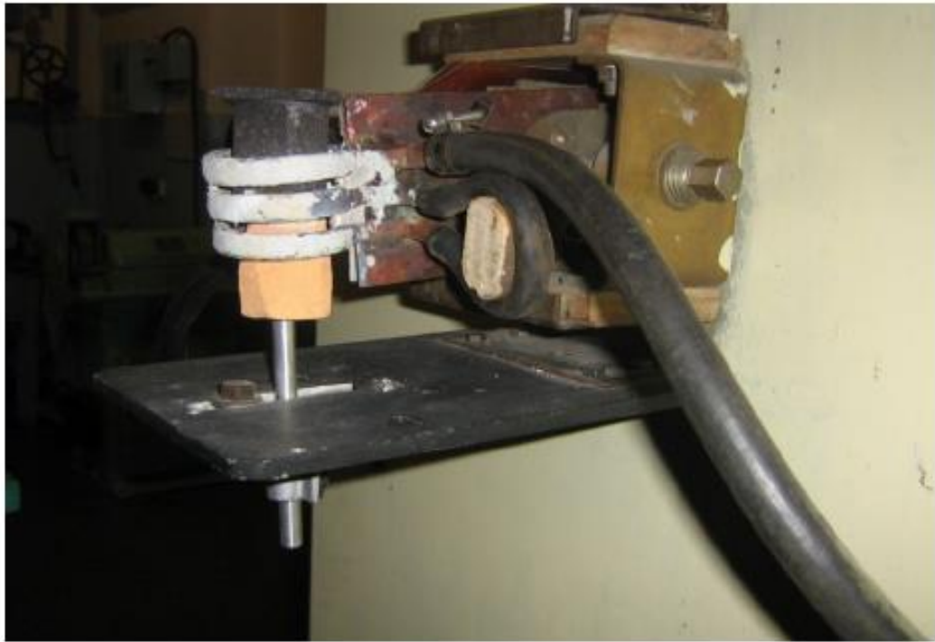
Рис 1.13. Індуктор високочастотної установки ВЧ-10У з тиглем для плавки алюмінієвих сплавів.
