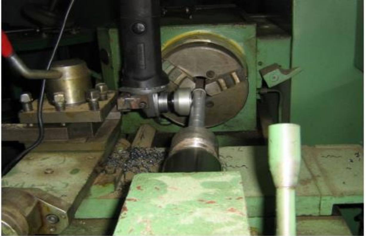
Рис. 3.21. Випробування абразивних властивостей покриття під час шліфування сталевого загартованого зразка.
