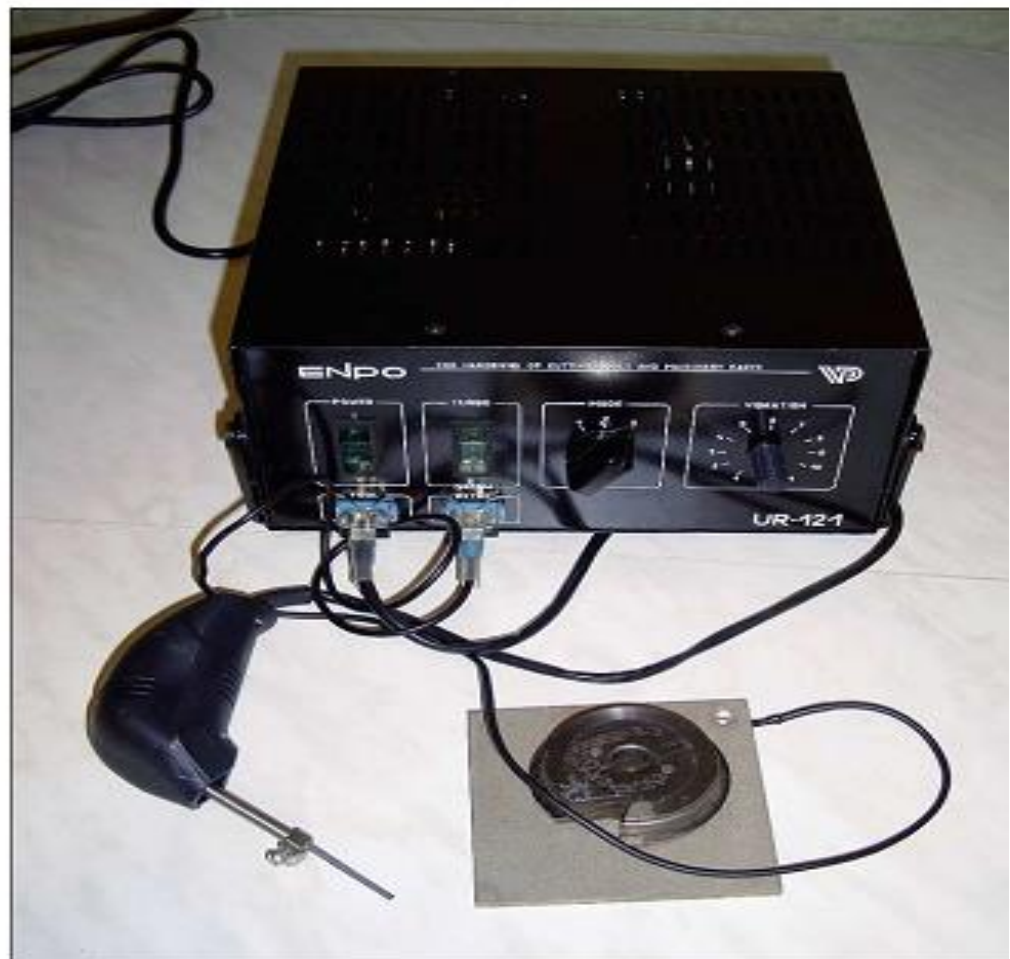
Рис. 3.19. Установка для электроискровой обработки ENPO.
