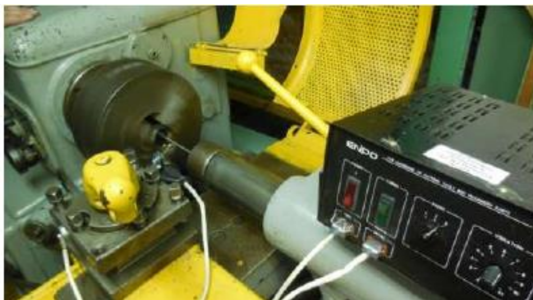
Рис. 3.10. Токарський верстат зі інтегрованої в нього установкою для електроіскровою обробки 1-ALIER 31.
