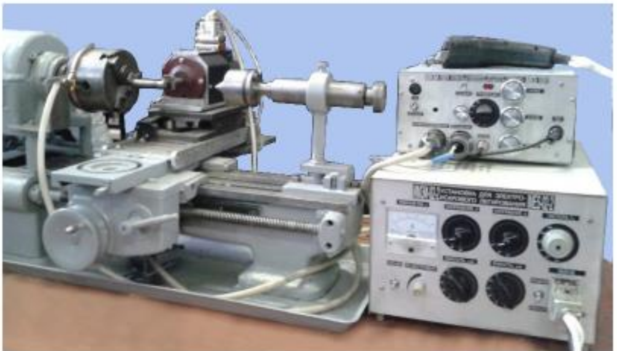
Рис. 2.4. Схема установки для механізованого ЕІО: 1 - база токарного верстата; 2 - ізолюваний кулачковий патрон; 3 - оброблювана деталь; 4 - ізолювана задня бабка; 5 - легуючий електрод; 6 - механізована головка з супортом верстата; 7 - стежить система; 8 - генератор імпульсів.
