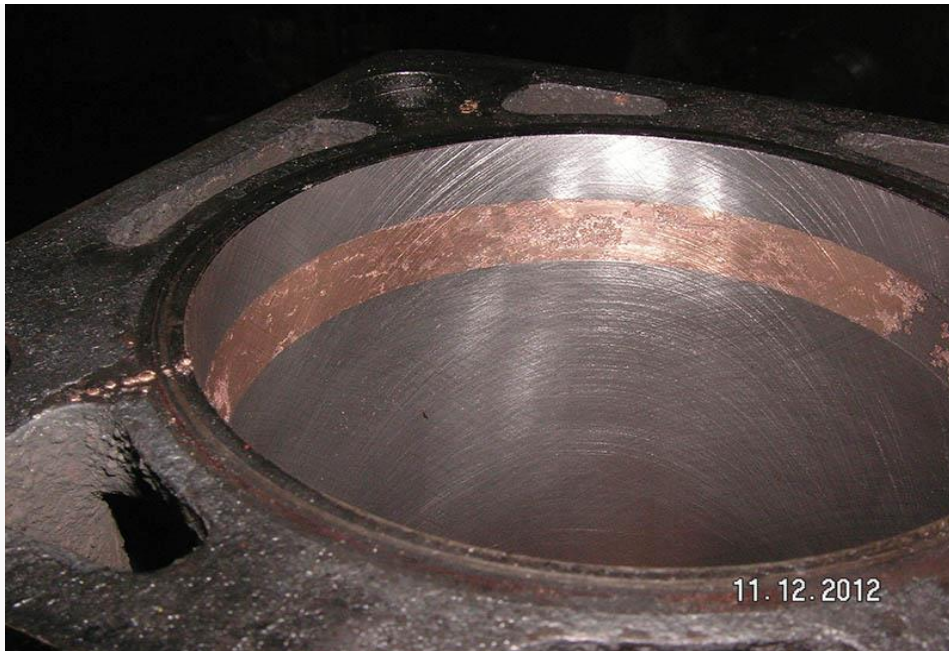
Рис. 3.16. Відновлені гільзи циліндрів двигуна CAT3116 (після механічної обробки).
