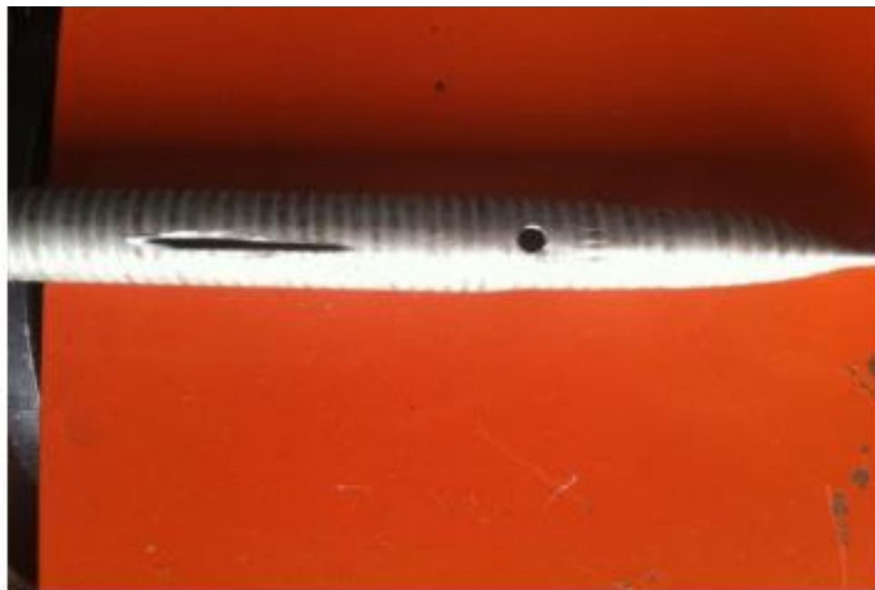
Рис.3.5. Трубка для запаювання з штучно зробленими ушкодженнями.
