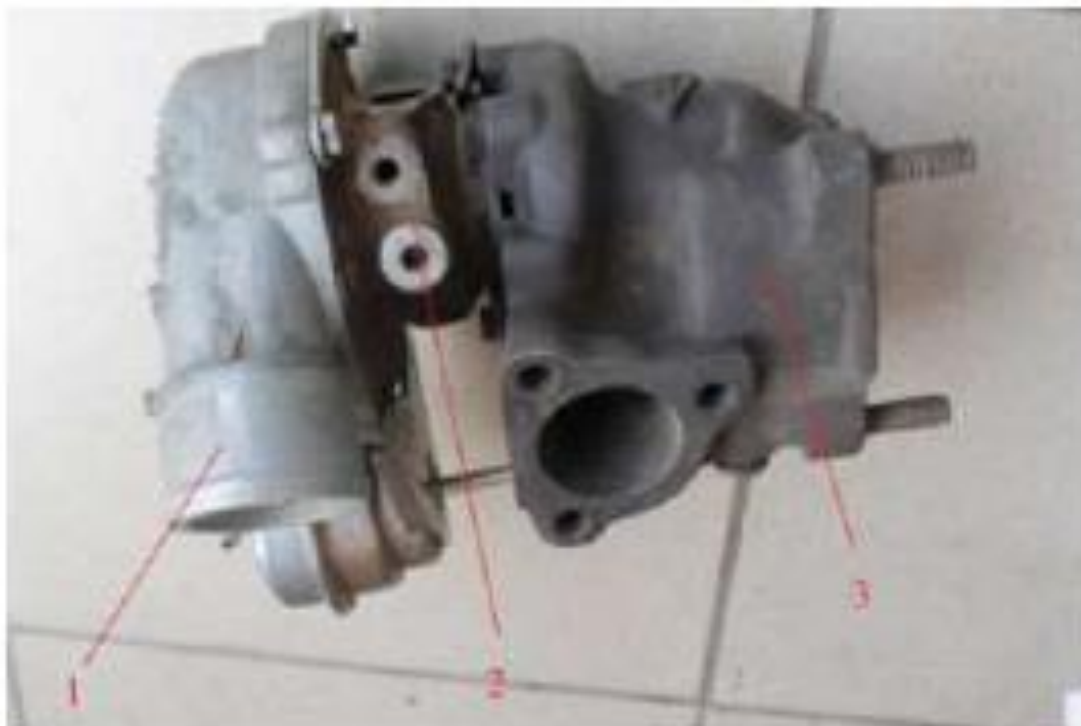
Рис. 3.7. Турбокомпресор: 1 корпус компресора, 2 середній корпус, 3 – корпус турбіни.
