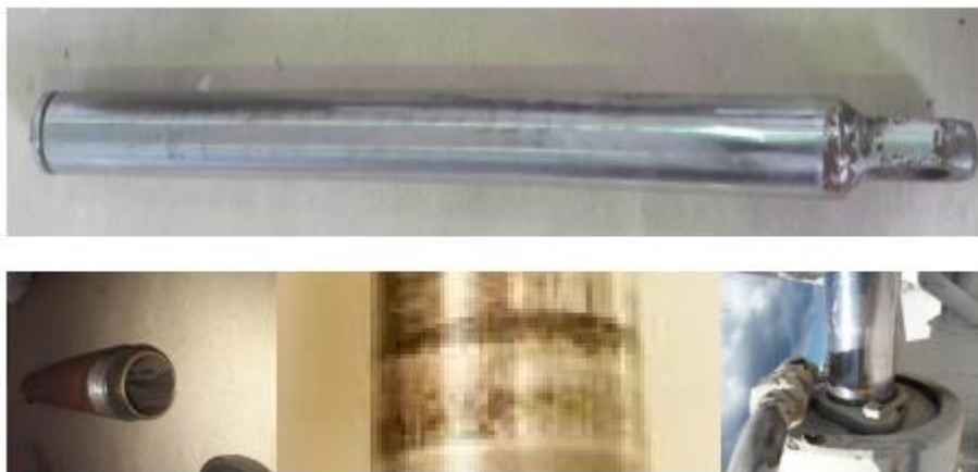
Рис. 3.26. Зовнішній вигляд зношених поверхонь деталей гідросистеми.
