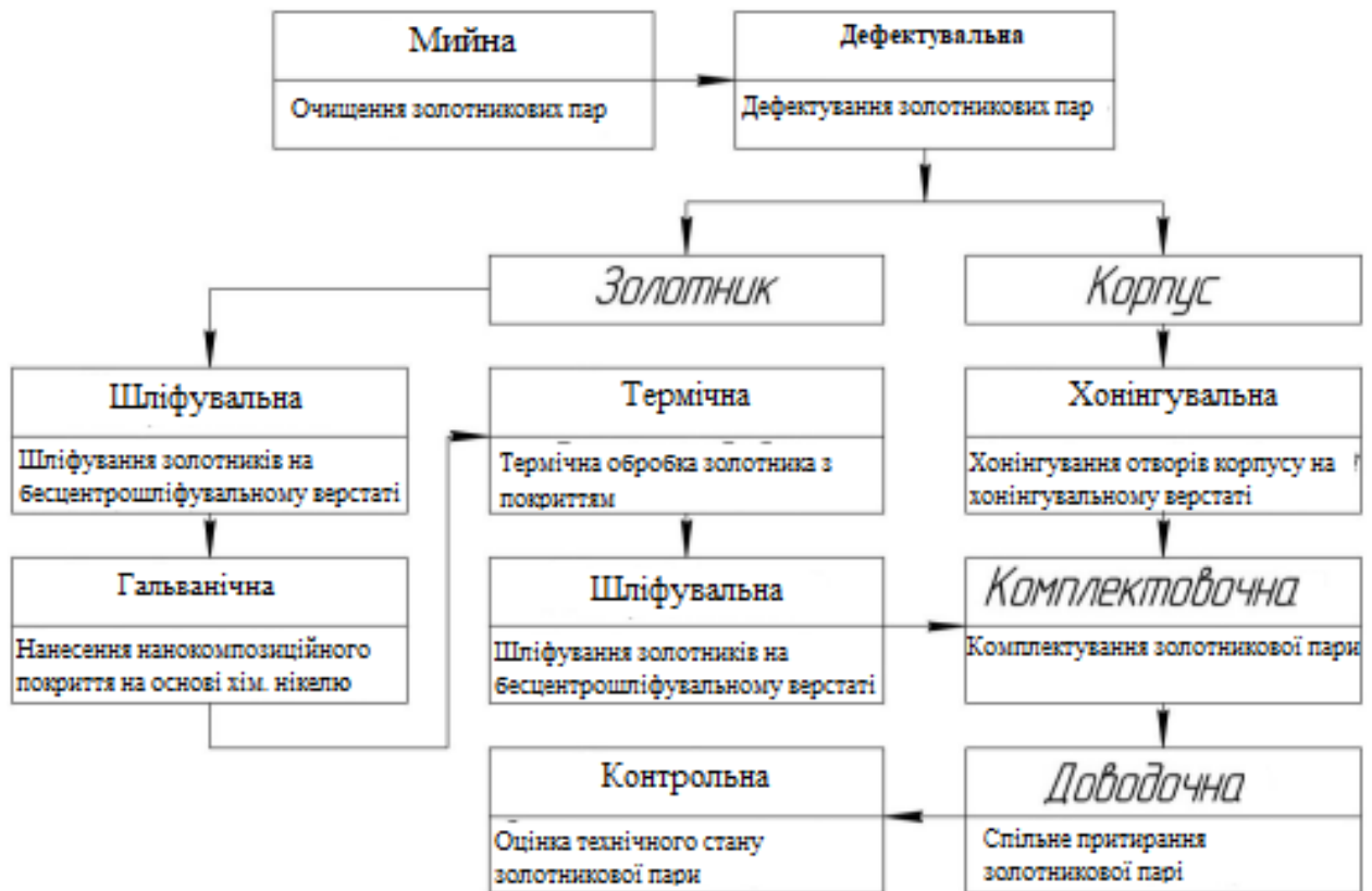
Рис.3.54. Схема технологічного процесу відновлення золотникових пар гідророзподільника.
