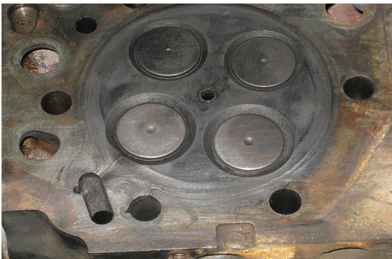
Рис. 3.12. Дефекти на площині роз'єму головки (а) і блоку (б) циліндрів дизельного двигуна DXi 11 вантажного автомобіля «ВОЛЬВО».
