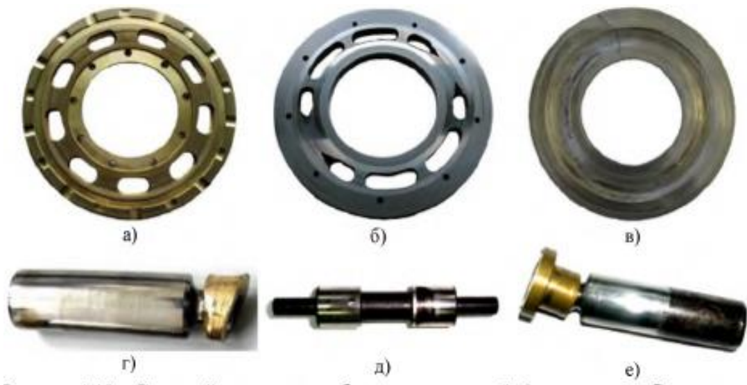
Рис. 3.29. Зовнішній вигляд зносу робочих поверхонь а) латунного та б) сталевого розподільників; в) опори; г) п'яти поршні; д) золотника клапанної коробки; е) поршня.
