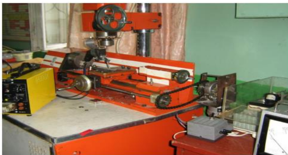
Рис 1.16. Установка електроіскрового легування для механізованого формування покриттів.
