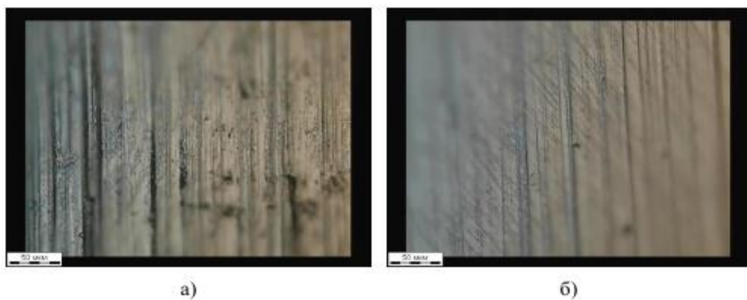
Рис. 3.61. Зовнішній вигляд (через мікроскоп) поверхні пояска золотника гідророзподільника після напрацювання 2000 мотогодин: а) серійного; б) зміцненого.
