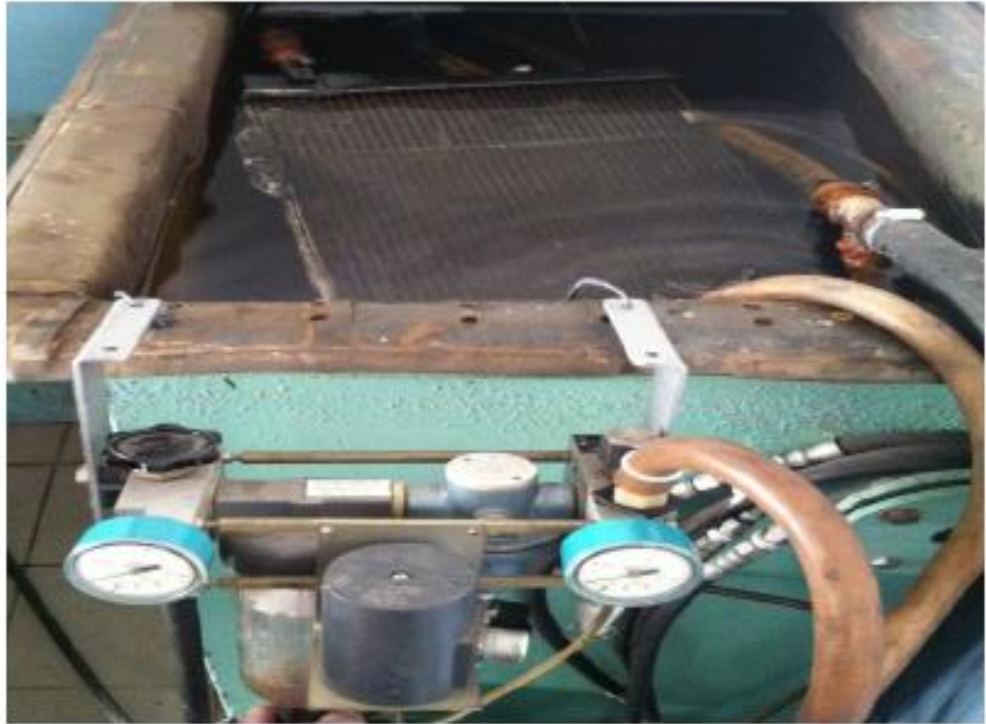
Рис. 3.3. Стенд для випробування автотракторних радіаторів.
