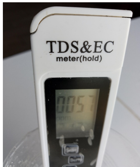
Рис. 5. Показники TDS-метра зразка очищеної води після очищення на лінії “ECOSOFT-6500”
