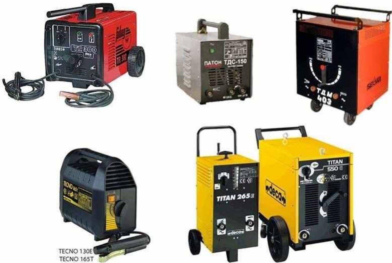
Рисунок 4.10. Однофазні зварювальні трансформатори для ручного дугового зварювання на змінному струмі з плавноступінчатим регулюванням
