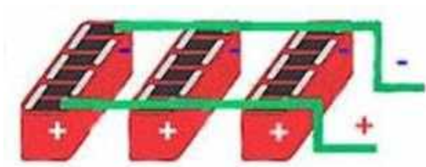
Рисунок 1.11 - Паралельне з'єднання акумуляторів
