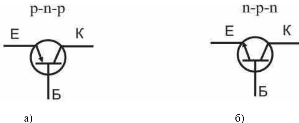
а) б) Рисунок 7.2 - Умовне зображення транзисторів
