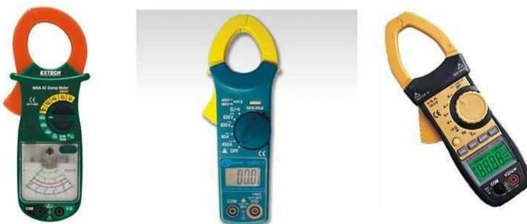
Рисунок 4.16 - Струмовимірювальні кліщі аналогові Extech AM600 (а), цифрові SMP-1 (б), McBrain VA318 (в)
