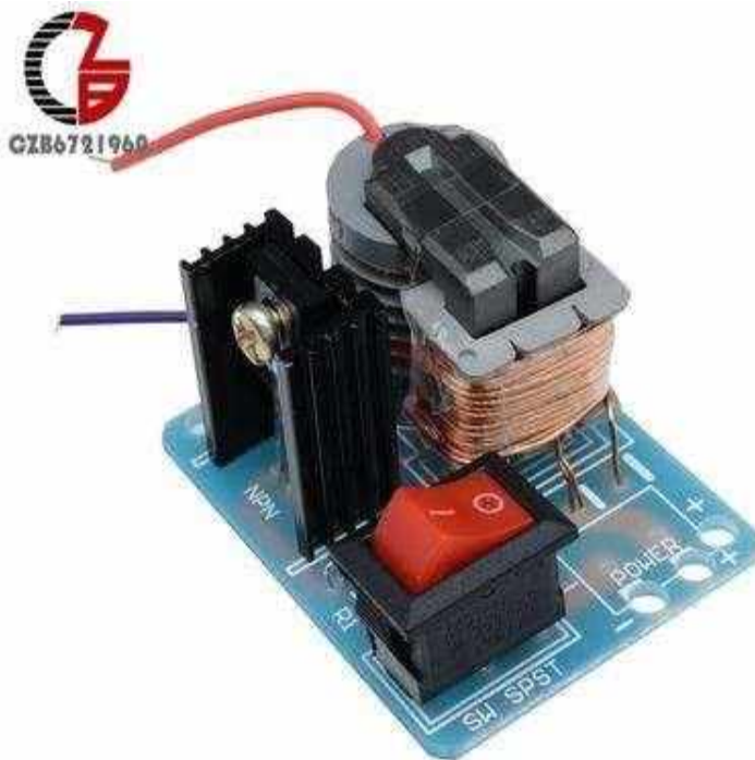
Рисунок 6.17 - Інверторний генератор високої напруги запалювання
