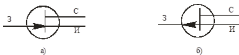
Рисунок 7.14 - Умовне позначення польового транзистора з p-n-переходом і каналом n- типу (а), каналом p- типу (б)
