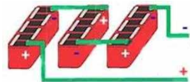
Рисунок 1.9 - Послідовне з'єднання акумуляторів
