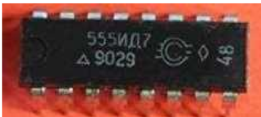
Рисунок 8.34 - Дешифратор двійково-десятькового коду в код семисегментного індикатора
