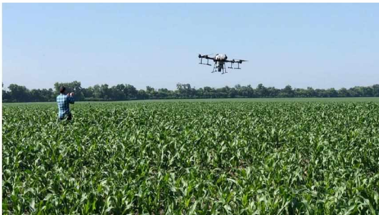
Рис.1 Застосування агродрона при внесенні ЗЗР на кукурудзі
