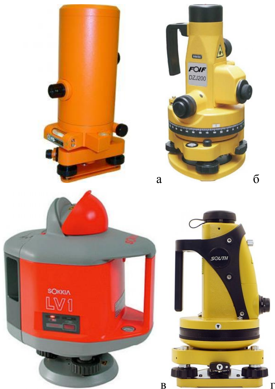
Рис. 1.20. Прилади вертикального проектування а – PZL-100; б – FOIF DZJ200; в – Sokkia LV-1; г – SOUTH ML-402
