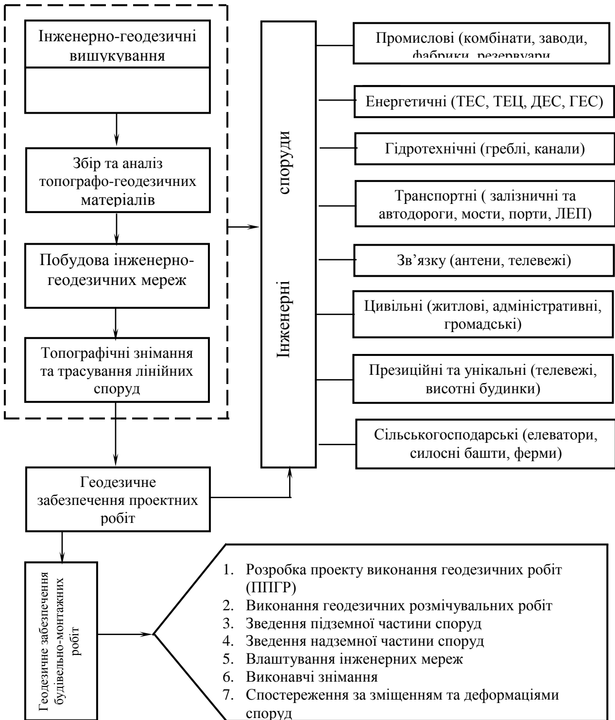
Рис. 4.12. Технологічна схема геодезичного забезпечення будівельного виробництва
