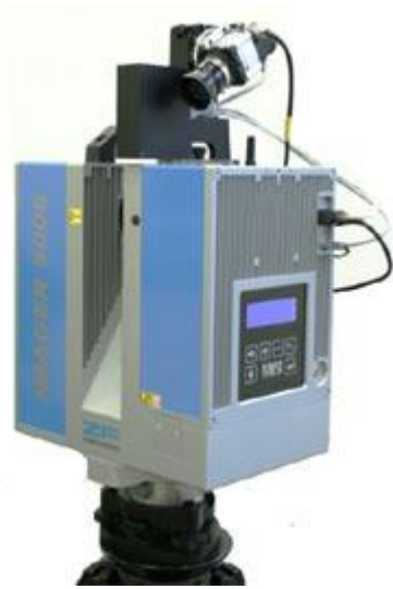
Рис. 3.7. Високоточний наземний лазерний сканер Z+F
