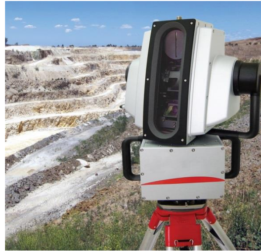
Рис. 3.7. Високоточний наземний лазерний сканер Z+F
