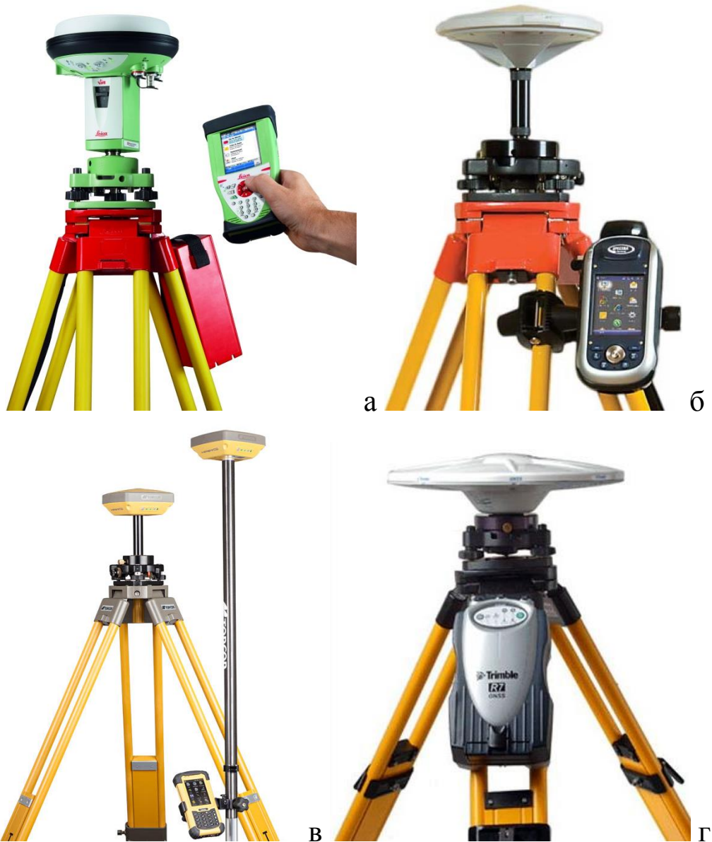
Рис. 1.1. Комплекти GNSS обладнання a – Leica Viva GS15; б – Spectra Precision ProMark 120; в – Topcon Hiper SR; г – Trimble R7
